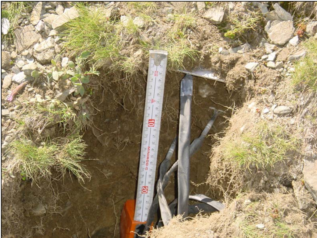
Figura 248. Sensores de temperatura en el nevado del Nevadín (NN). Se pueden ver tres sensores, situados a -2 cm, -8 cm y -15 cm. 13-sep-2003.
