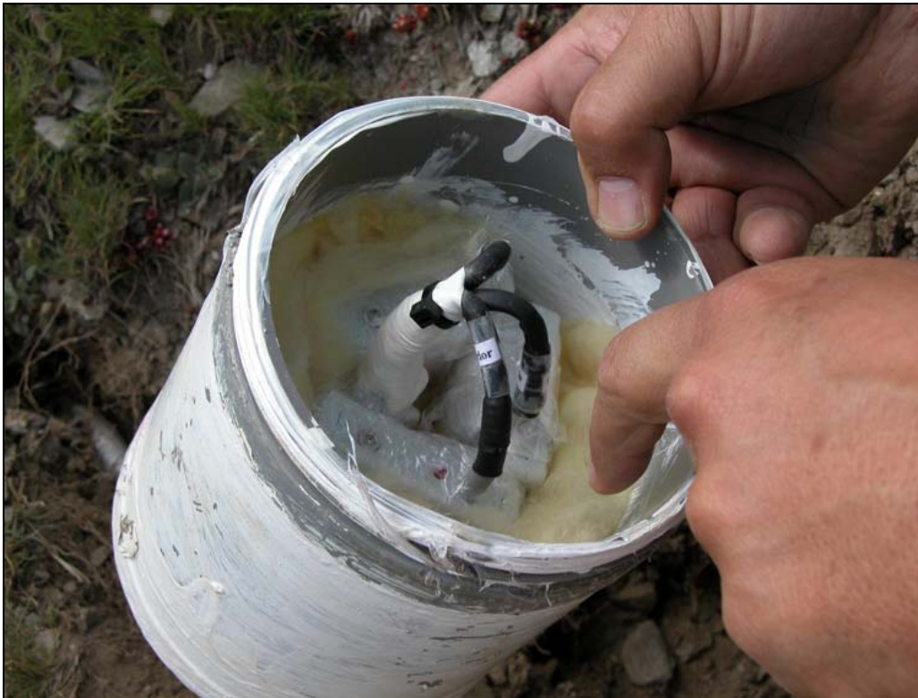
Figura 247. Caja protectora de los registradores de temperatura que almacenan los datos obtenidos a tres profundidades diferentes, en el Nevero del Nevadín (NN). 22-jul-2004.
