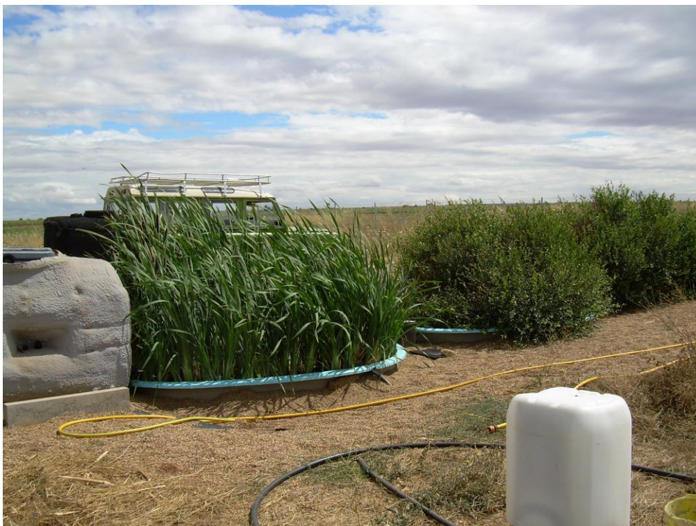
Figura 2.13. Sistema completo: tanque de dilución, balsa con Typha latifolia y flujo superficial y las dos siguientes con Salix atrocinerea y flujo subsuperficial. Del sistema de depuración piloto de Centrotec.
