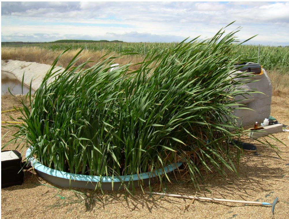
Figura 2.12. Tanque de dilución y primera balsa con Typha latifolia y flujo superficial. Del sistema de depuración piloto de Centrotec.
