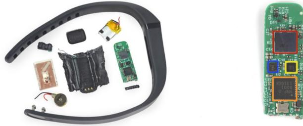
Figura 14. Fitbit Flex®, componentes y microcontrolador STM32L151. Tomado de ifixit.com.
