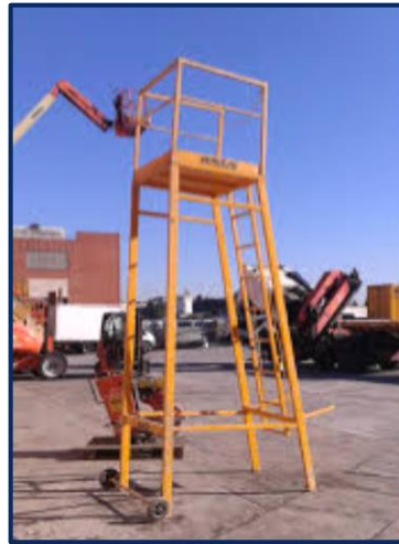
Fotografía 40. castillete de hormigonado. Fuente: GISA
