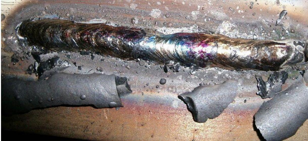
*Figura 3.36 Cascarilla SMAW (Fuente: reparatucultivador.com)*
