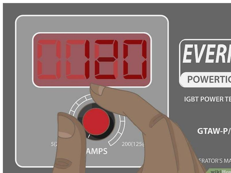
Figura 3.27 Ajuste del amperaje (Fuente: Wikihow.com)
