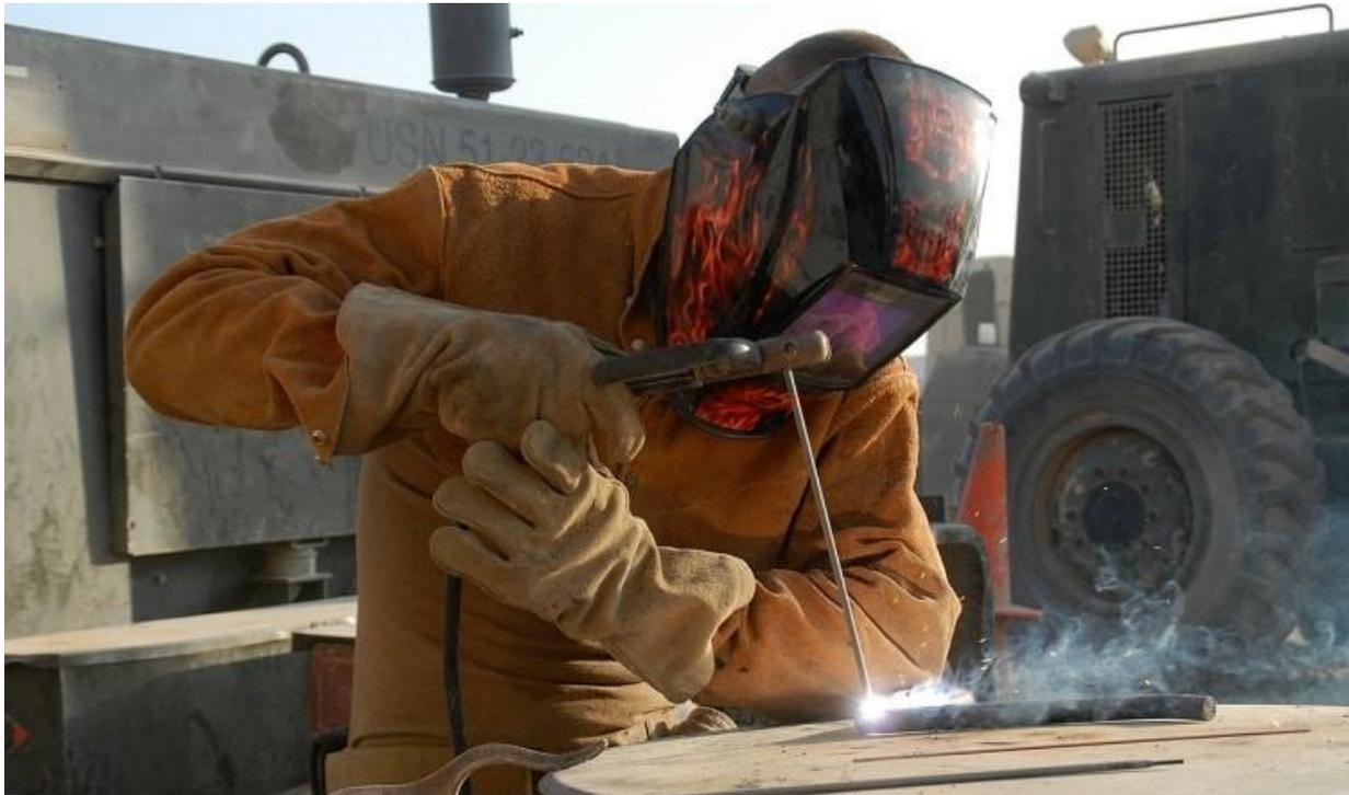
*Figura 3.28 Soldadura SMAW (Fuente: differencebox.com)*
