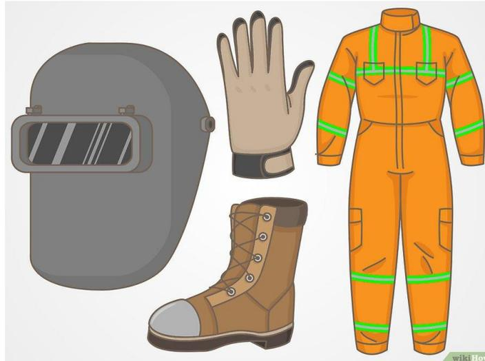
Figura 3.22 EPI's soldadura (Fuente: Wikihow.com)
