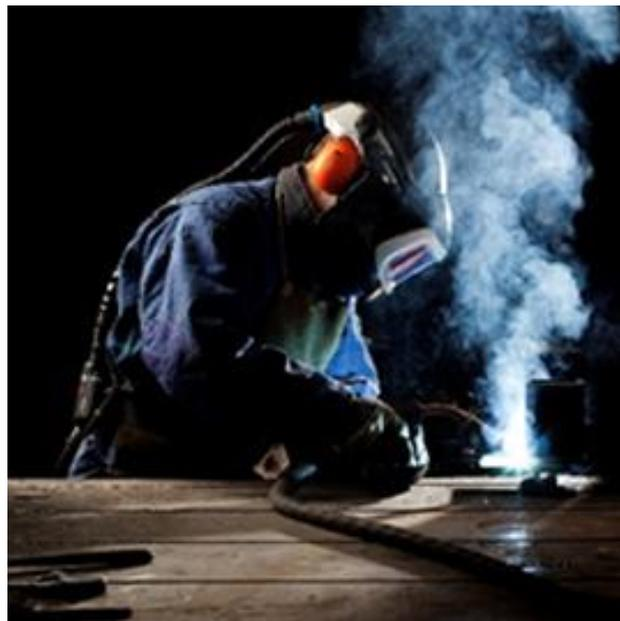
*Figura 0.10 Equipo de respiración semiautonomo (Fuente: 3M)*
