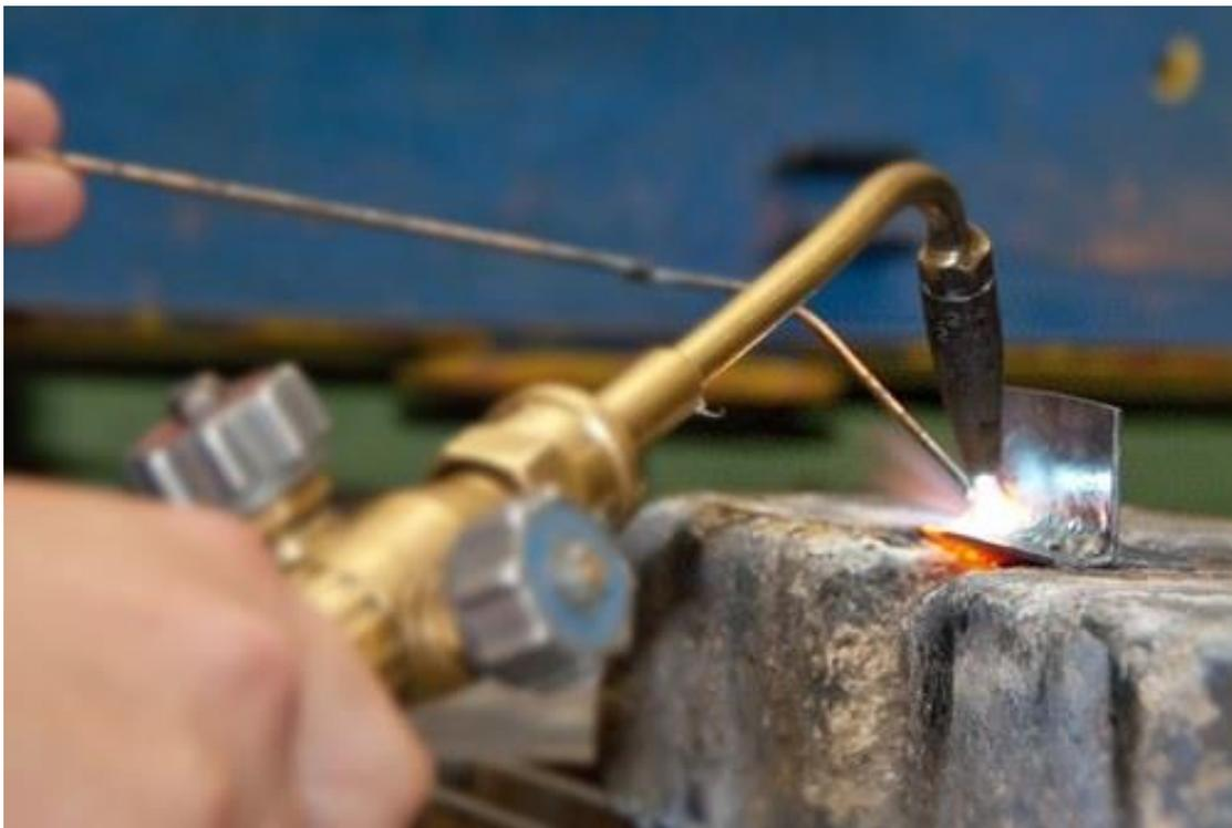
*Figura 3.2 Soldadura OAW (Fuente: hilenia2011.com)*
