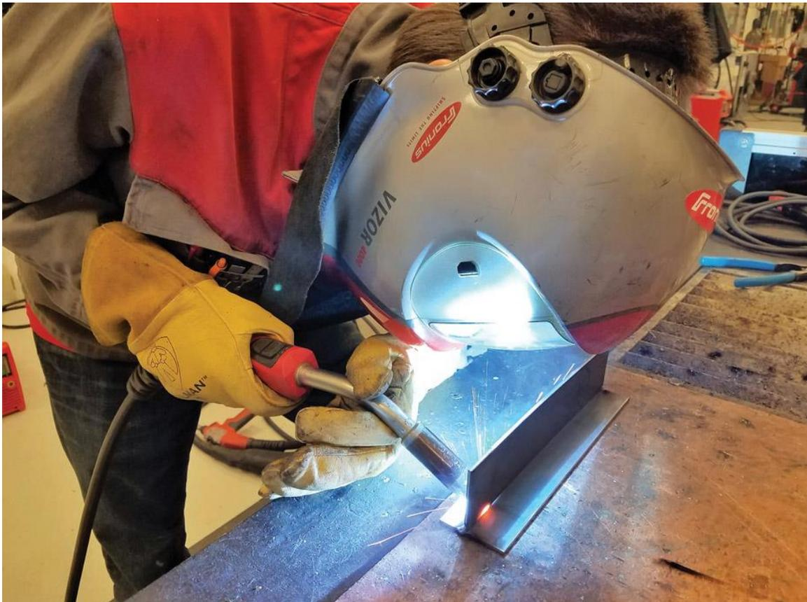
Figura 3.37 Soldadura GMAW (Fuente: fbrmuntatges.com)
