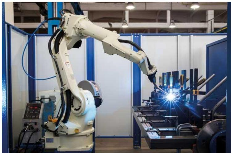
*Figura 3.1 Robot de soldadura (Fuente: rivasrobotics.com)*
