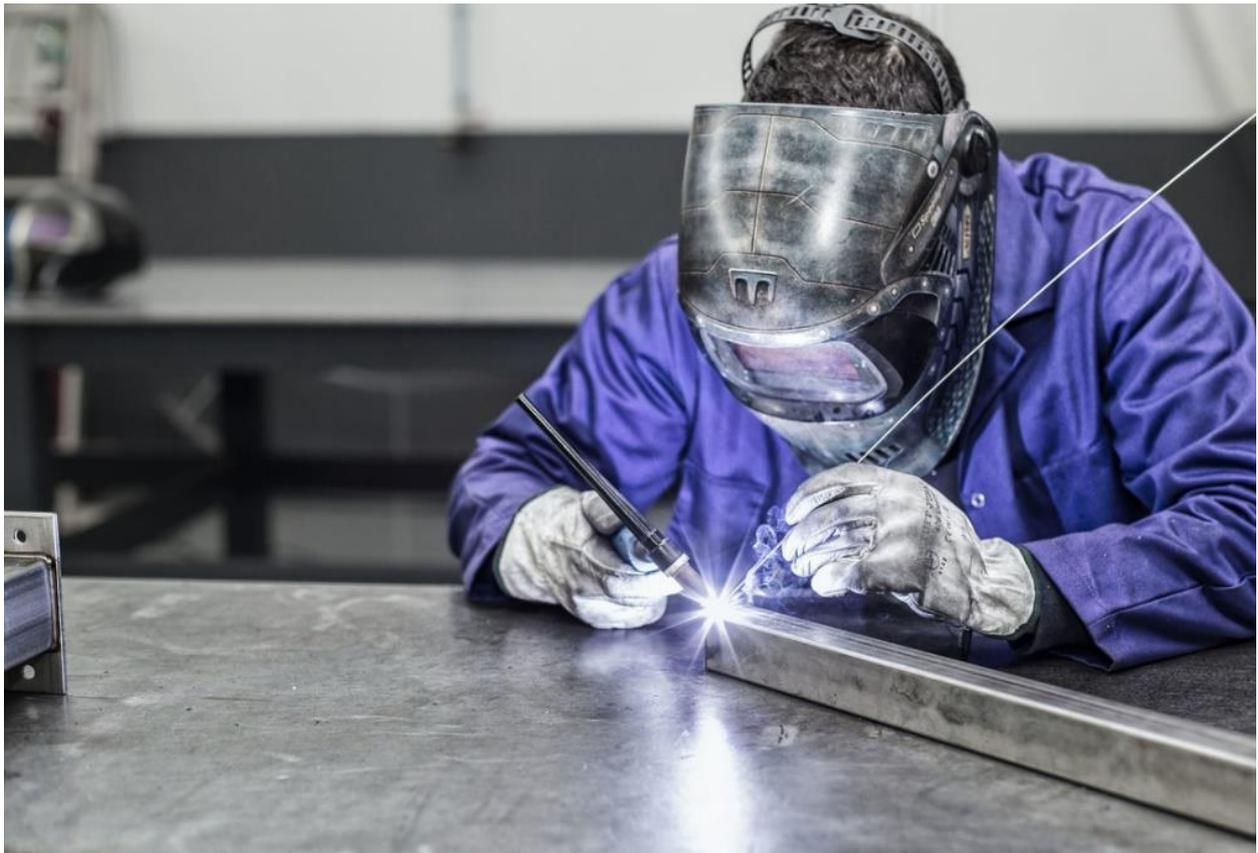
*Figura 3.15 Soldadura GTAW (Fuente: fbrmuntatges.com)*
