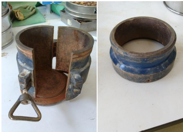
ILUSTRACIÓN 21: MOLDE (IZQUIERDA) Y COLLAR (DERECHA) PARA PROCTOR NORMAL (FUENTE: ELABORACIÓN PROPIA)
