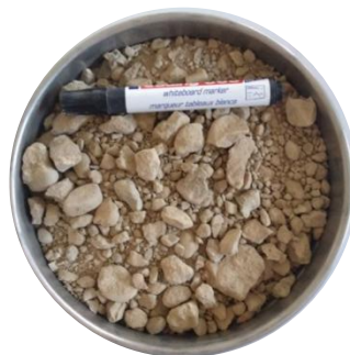
ILUSTRACIÓN 4: ÁRIDO 100% HORMIGÓN RECICLADO CON GRANULOMETRÍA 25/0 mm
