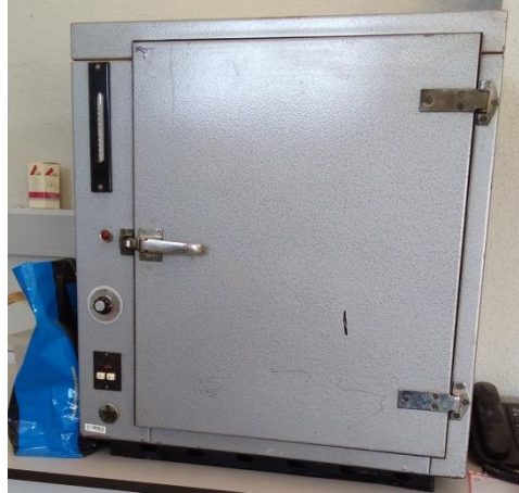
ILUSTRACIÓN 7: ESTUFA VENTILADA (FUENTE: ELABORACIÓN PROPIA)
