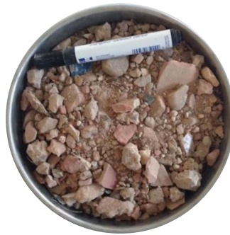
ILUSTRACIÓN 5: ÁRIDO RECICLADO MIXTO CERÁMICO CON GRANULOMETRÍA 16/0 mm
