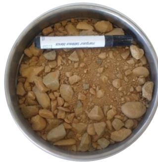
ILUSTRACIÓN 3: ZAHORRA ARTIFICIAL CON GRANULOMETRÍA 20/0 mm
