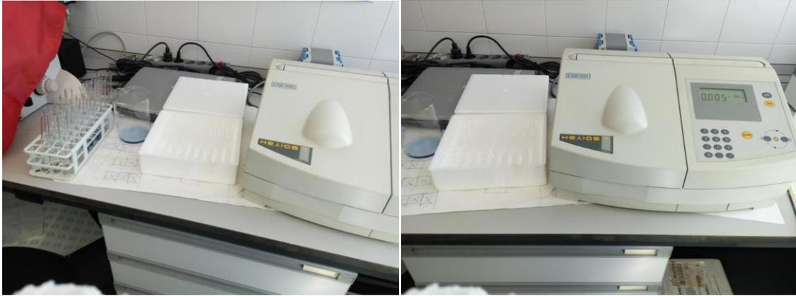
Figura 17: Imágenes del espectrofotómetro, utilizado para el análisis de fosfatos en el agua en el laboratorio.
