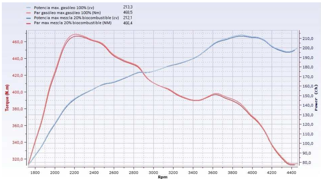
Figura 3. Comparativa rendimiento en motor diésel ligero con electrónica ajustada a medida.
