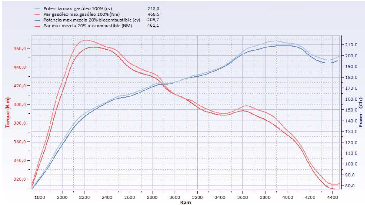
Figura 2. Comparativa rendimiento en motor diésel ligero sin ajustar la electrónica
