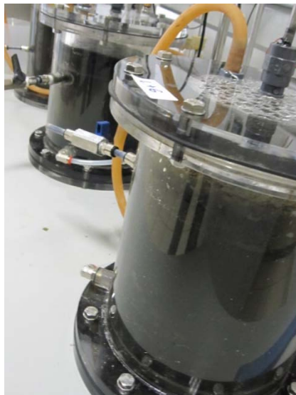
Figura 3.2 Banco de digestores de 3 L usado en los ensayos de digestión anaerobia en semicontinuo
