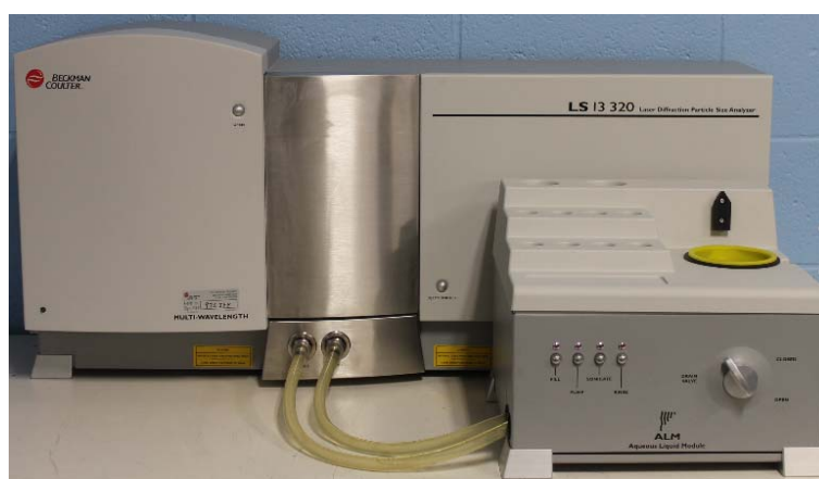
Figura 2.4 Equipo para la determinación del tamaño de partícula
