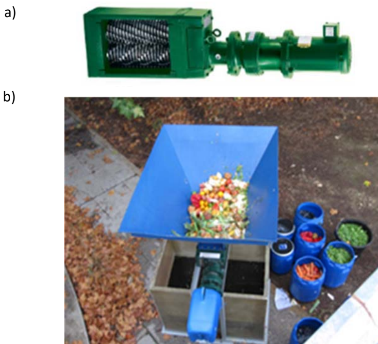
Figura 6.4 a) Triturador JWCE Muffin Monster; b) Unidad de pretratamiento
