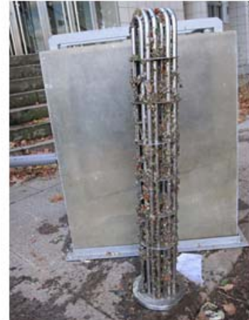
Figura 6.6 Intercambiador de calor. a) Integrado en el sistema de calefacción; b) Desmontado
