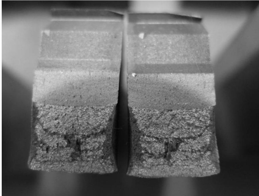
Figura 15. Detalle (1) de la superficie de fractura de una de las probetas CTOD.
