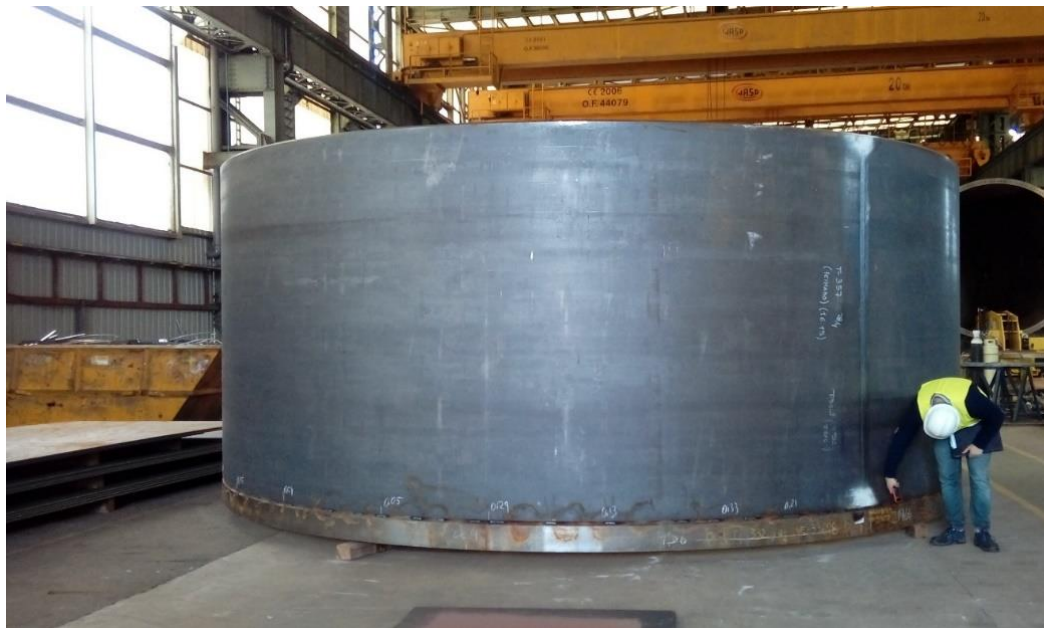
Figura 10. Sección cilíndrica de una torre Offshore para un prototipo de aerogenerador de 8MW. Las probetas de homologación de la soldadura utilizada para unir la virola (soldadura longitudinal) y la virola a la brida (soldadura circular) fueron parte de set experimental.
