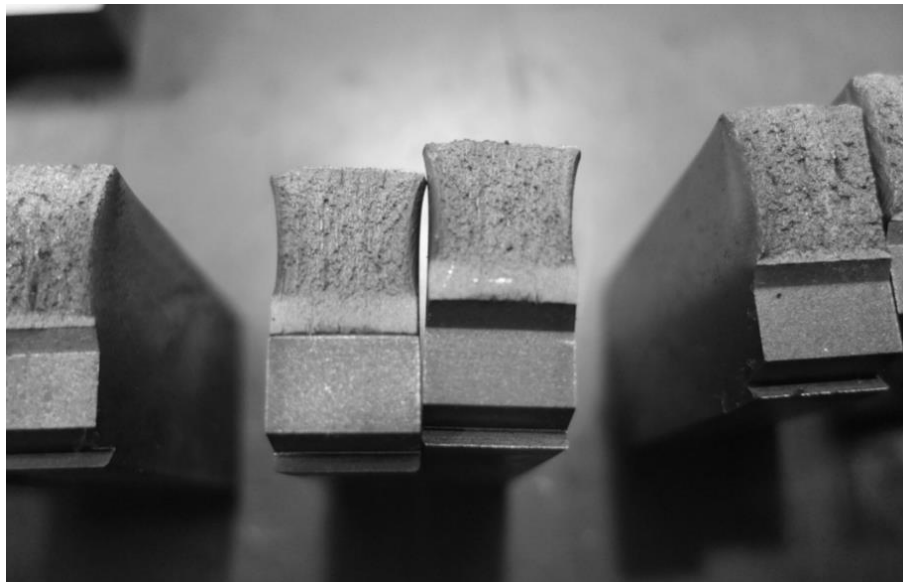
Figura 16. Detalle (2) de la superficie de fractura de una de las probetas CTOD.
