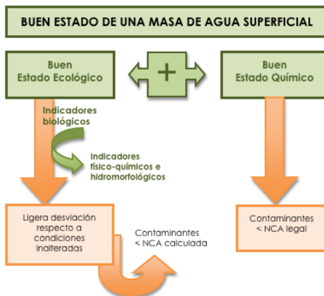
Figura 1. Definición del Buen Estado de aguas superficiales según la DMA.
