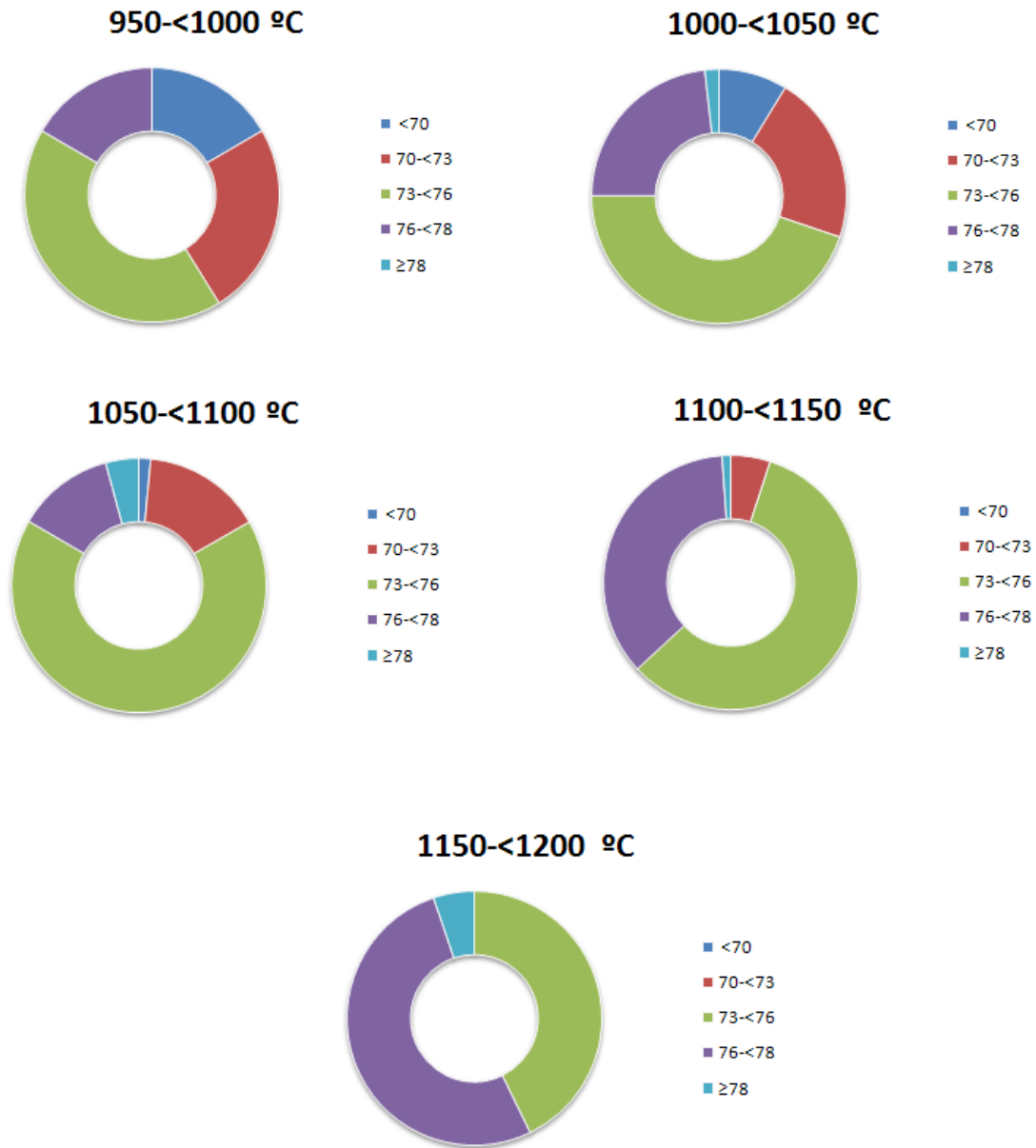
Figura 4.16. Se representan los porcentajes de C 3 S en cada tramo de Temperatura aire secundario entrada enfriador.
