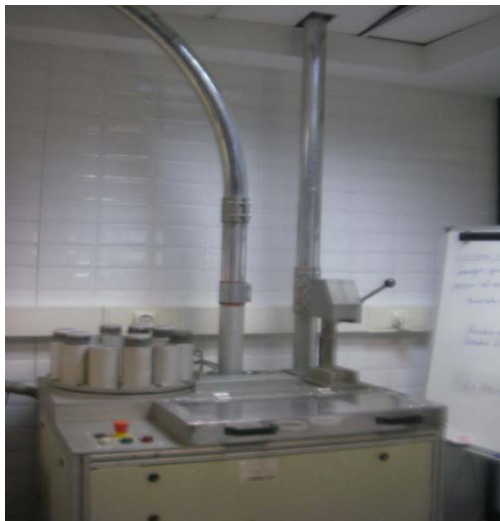
Figura 2.7. Circuito neumático de toma de muestras del carbón.
