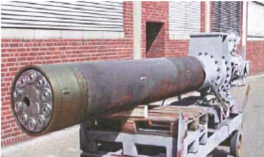
Figura 1.37. Vista de la caña del quemador
