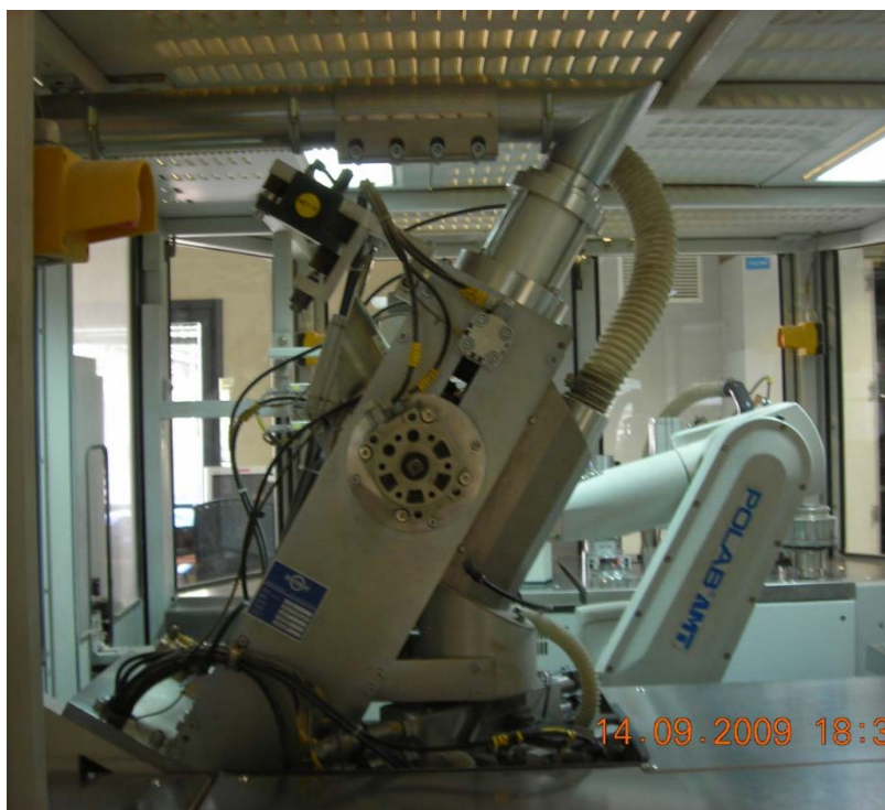
Figura 2.9. Entrada cartucho con materia prima al robot
