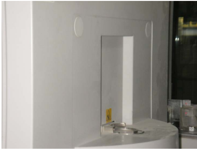
Figura 2.3. Difractómetro, entrada pastilla.
