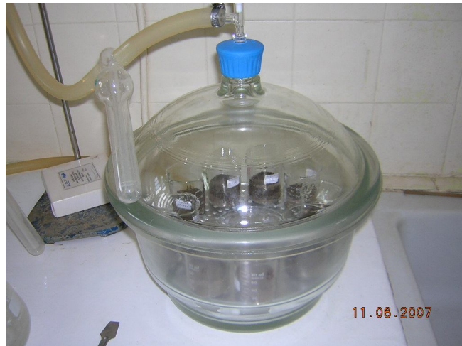
Figura 3.6.1. Desecador de vacío con las muestras de suelo en proceso de fumigación con cloroformo.
