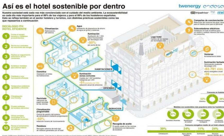
Figura 5.1 Estructura de un hotel sostenible.
