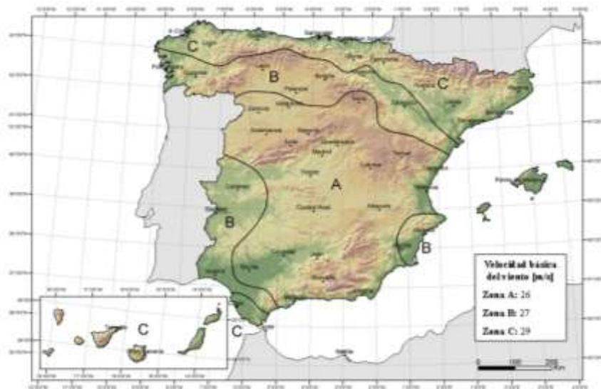
**Figura 8. Valores de la velocidad del viento (m/s) en función del emplazamiento geográfico (España. Ministerio de la Vivienda, 2006, p. 23).**
