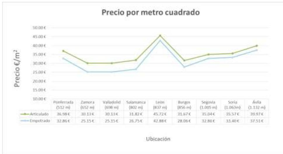
Figura 27. Valor de los pórticos en €/m<sup>2</sup> en las distintas ciudades de Castilla y León. Se muestran los pórticos biarticulados y biempotrados. Pórticos de 20 m de luz, 6 m de altura y 15 % de pendiente.
