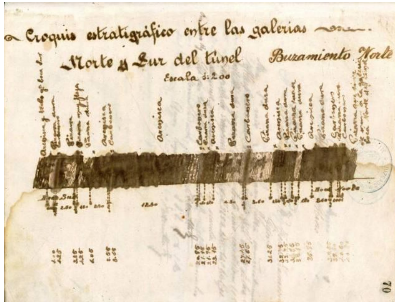
Ilustración 8. Estratigrafía al Norte y Sur del túnel de La Boqueriza. Elaborado por Aquiles Paternotte a comienzos de 1902. ARIDEA/GF-MR. Administración. 1134/3.
