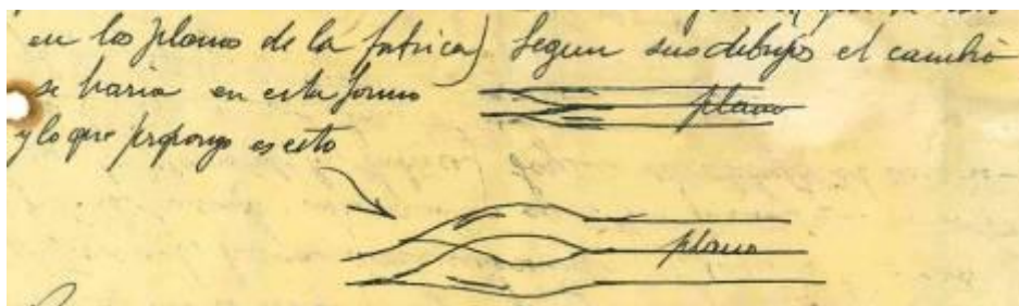
Ilustración 65. Cambio de vías propuesto por Eduardo Medley.
