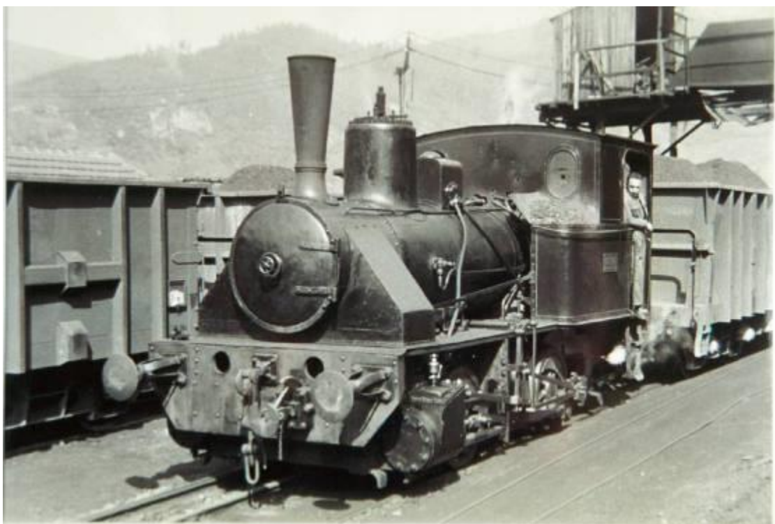
Ilustración 70. Locomotora Orestein Koppel de 20 toneladas.
