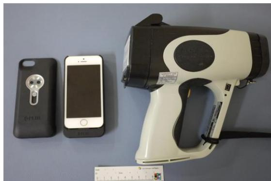
**Figura 23.** El dispositivo FLIR ONE conectado a un teléfono inteligente (izq.) y un termógrafo rutinario (dcha.) (*Kanawaza et al.*, 2016).
