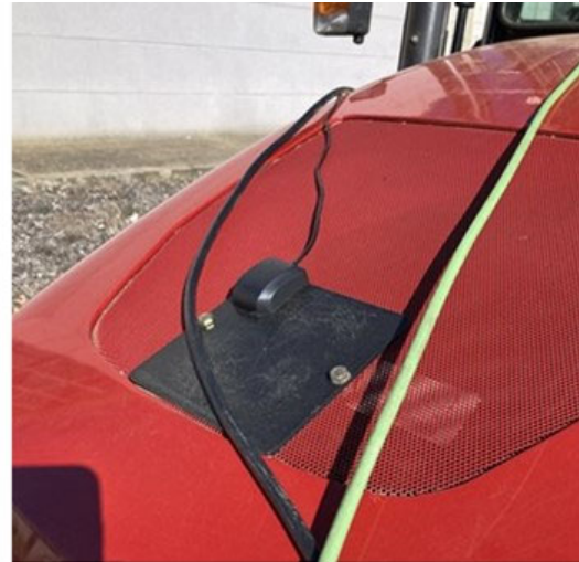
Figura 18. Módulo GNSS y montaje en tractor
