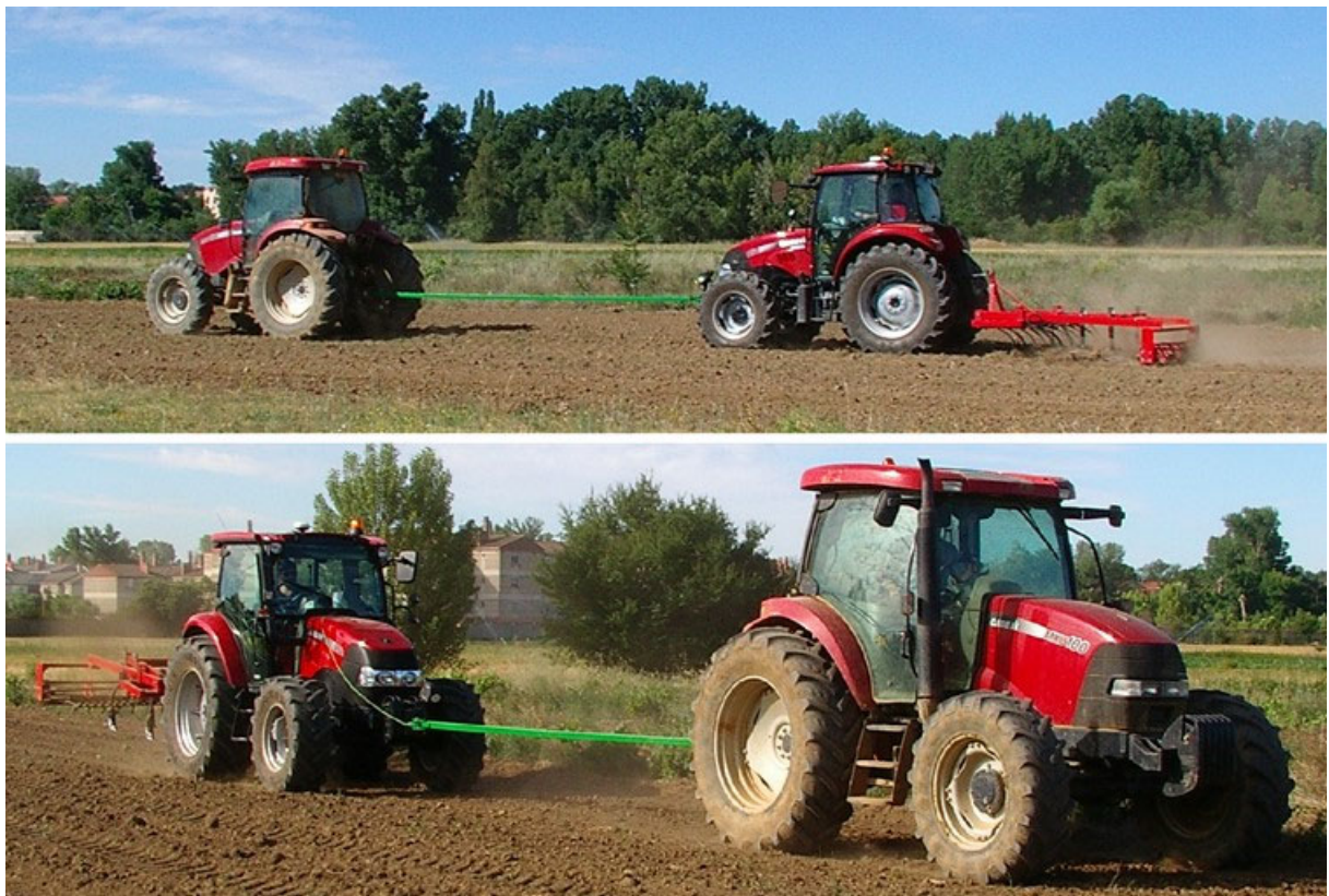
Figura 33. Ensayo de tracción en suelo con laboreo superficial.
