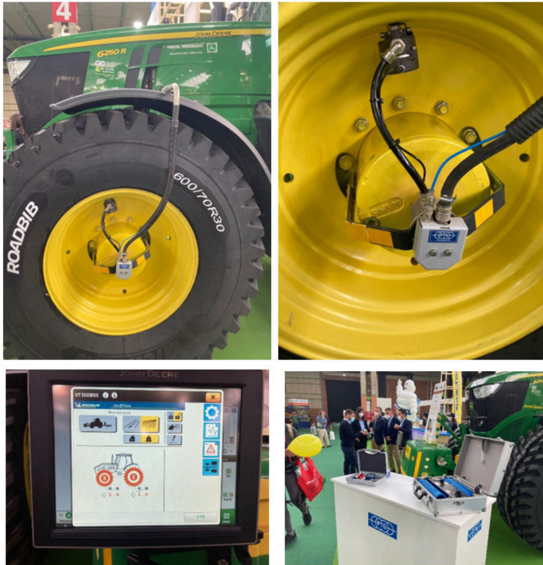
Figura 4. Sistema de teleinflado de Michelin, que aprovecha el circuito neumático que incorporan algunos tractores (FIMA 2022).
