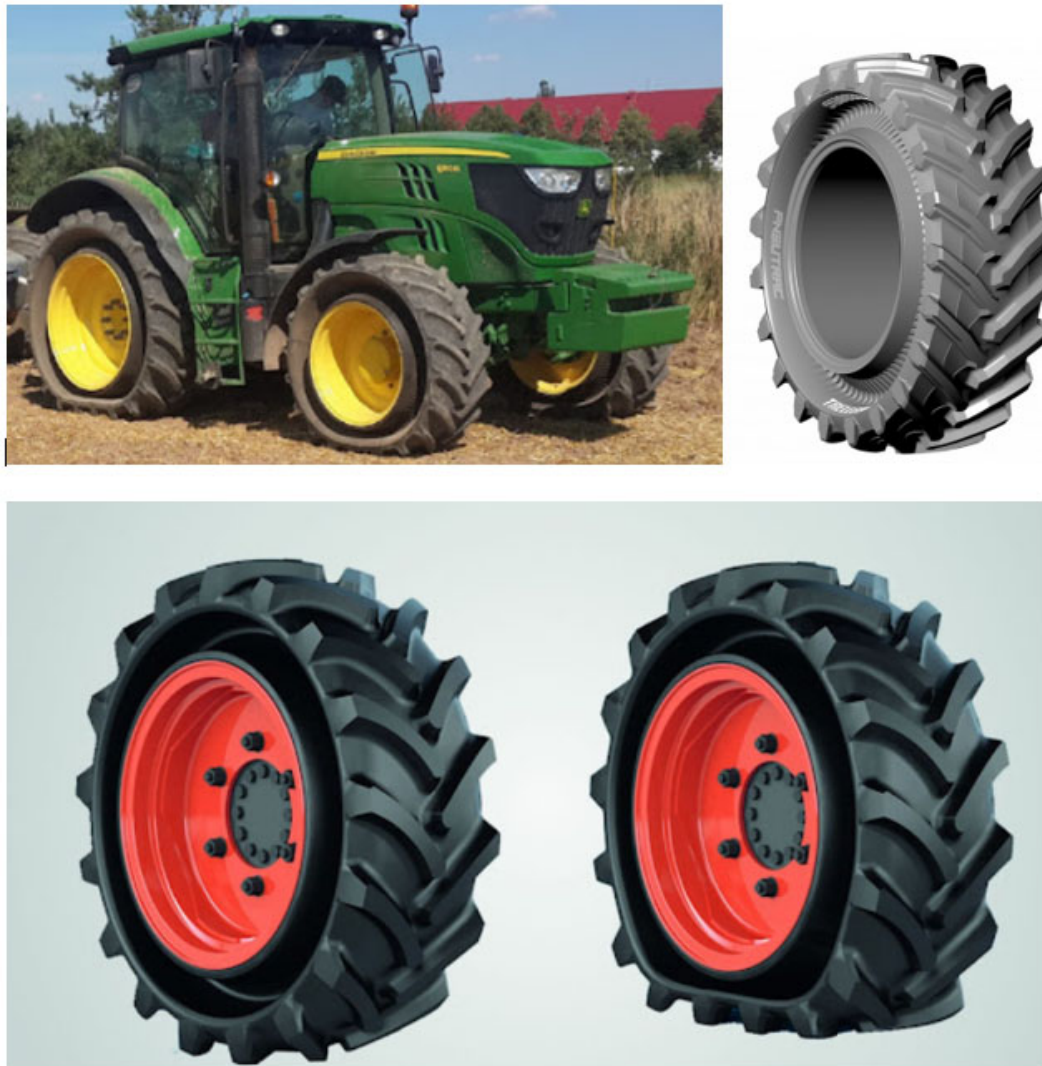
Figura 3. Capacidad de deformación del neumático Pneutrac de Trelleborg,(Trelleborg).
