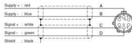
Figura 12. Especificaciones de la célula de carga Magtrol LB214
