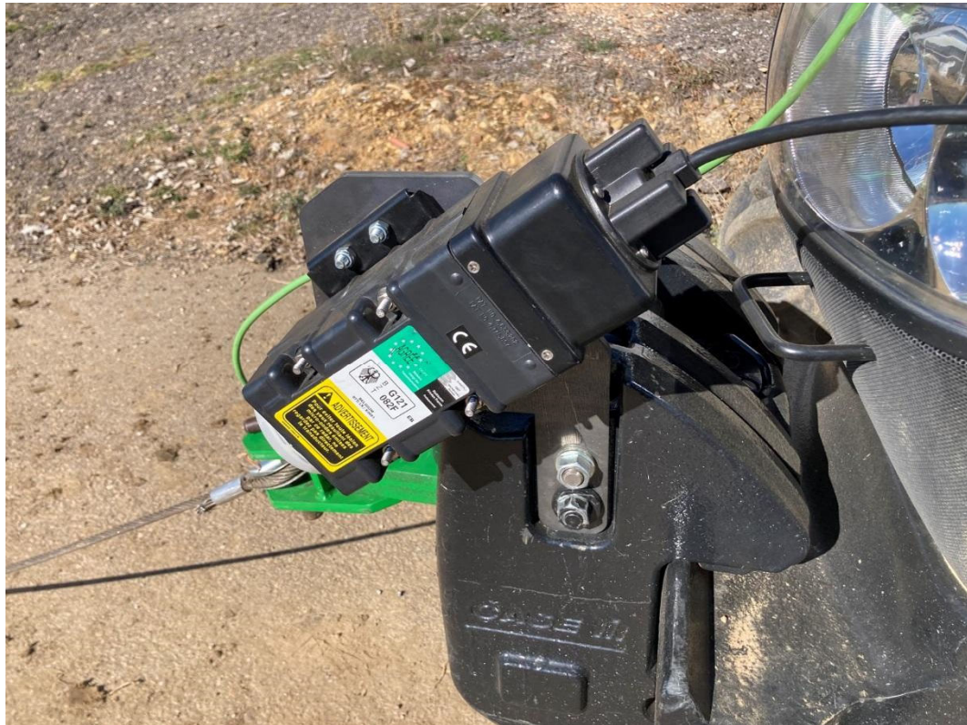
Figura 17. Detalle de instalación del radar doppler
