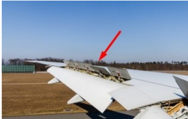
Figura 2.25. Spoilers desplegados en una aeronave [12]
