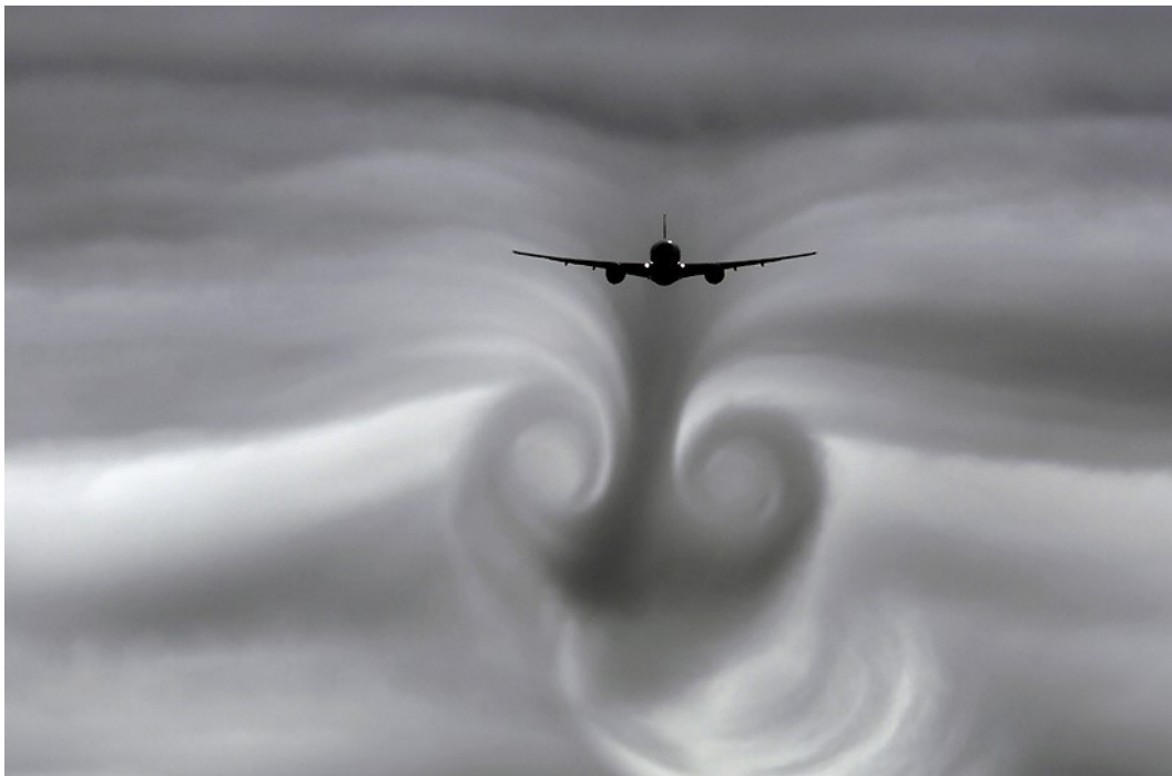
Figura 2.16. Vórtices de punta de ala de avión [7]
