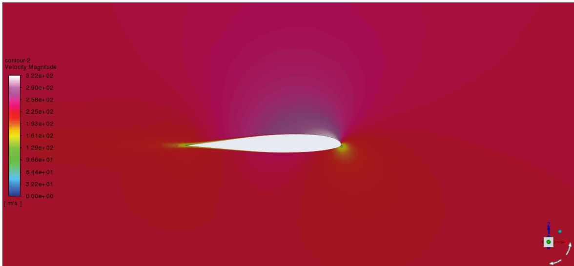
Figura 6.22. Distribución de velocidades con winglet a 10 m [Creación propia]
