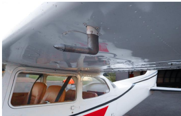
Figura 2.2 Tubo Pitot en un avión. Fuente: https://www.naa.edu/pitot-tube/
