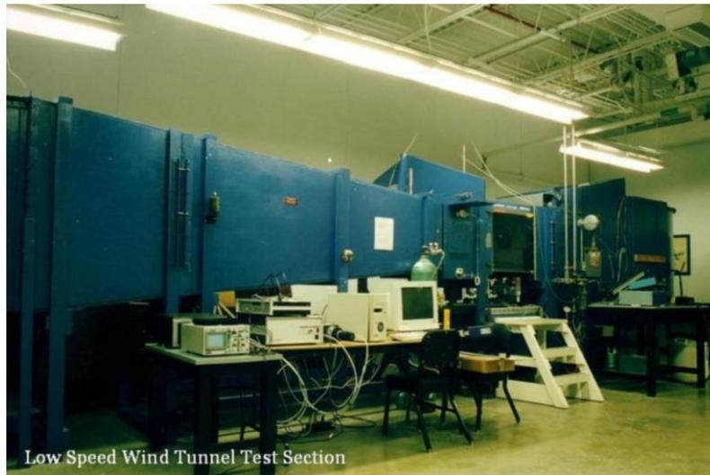
Figura 3.7. Túnel de viento de baja velocidad de la Universidad de Texas en Arlington
