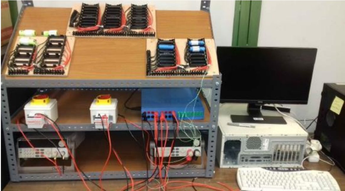
Figura 2.20.- Banco de ensayo de baterías eléctricas de la UVA
