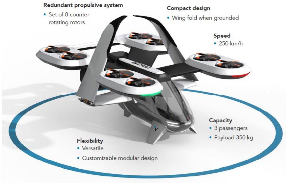
Figura 0.2.- Diseño del eVTOL de Altran y sus principales características
