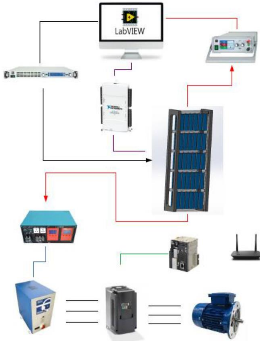
Figura 2.1.- Diagrama de conexión completo del banco propuesto
