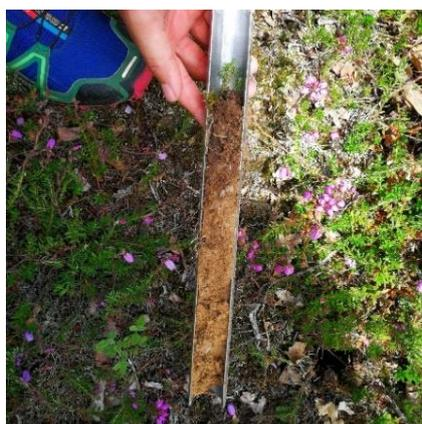
Figura 15: Sonda con la muestra de tierra de 0-30 cm, antes de separar las dos profundidades analizadas.
