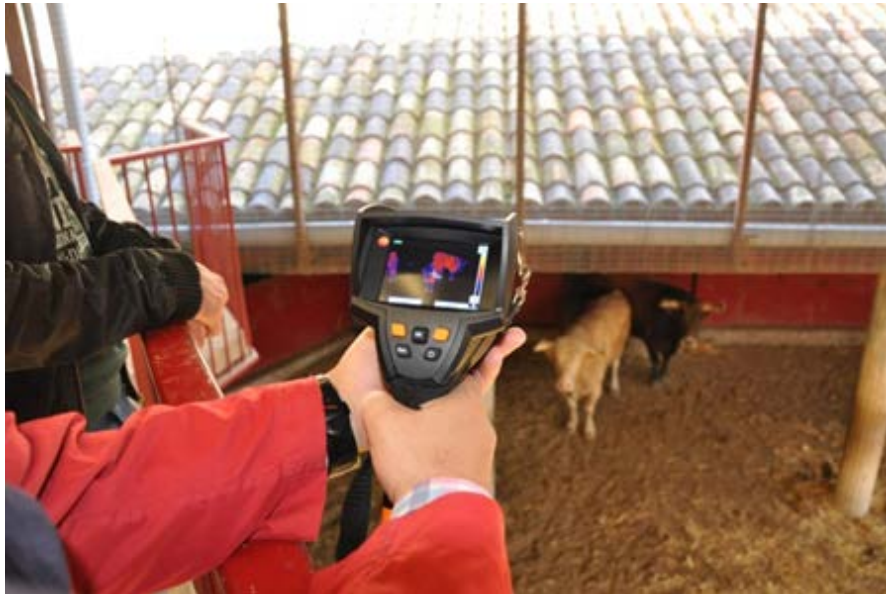
FIGURA 3: toma de fotografías con cámara termográfica FLIR T-460.
