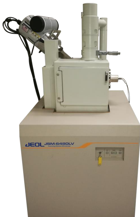
Figura 3.19. SEM JSM-6480LV – disponible en el LTI (ULE).
