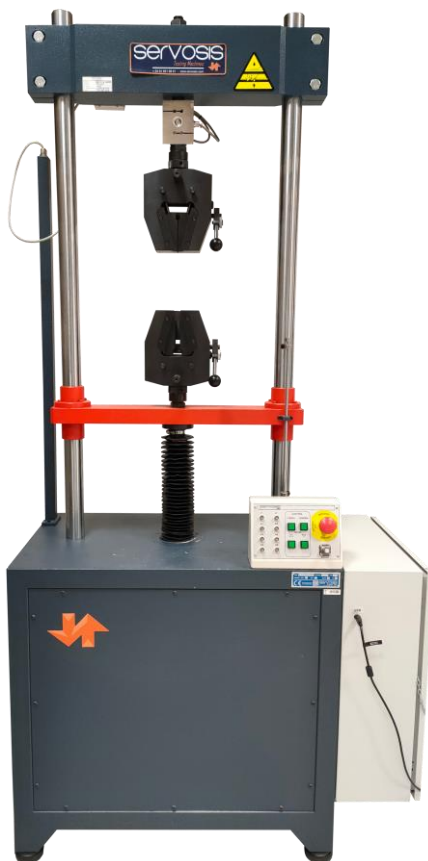
Figura 3.24. Máquina universal de ensayos ME-402/5 – disponible en la UFI3D (ULE).
