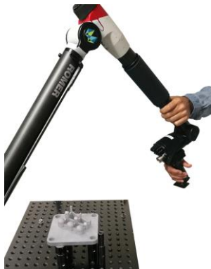
Figura 8.5. Medición óptica de la pieza patrón de esferas utilizando: (a) escáner láser instalado en CMM, (b) sensor de holografía conoscópica, (c) escáner láser integrado en CMA, (d) escáner láser portátil y (e) escáner de luz estructurada.
