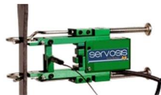
Figura 3.25. Extensómetro axial para ensayos de tracción (Servosis, 2018) – disponible en la UFI3D (ULE).
