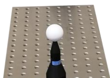
Figura 3.30. Proceso de calibración del sensor de escaneo láser HP-L-10.6 – disponible en los Laboratorios de Metrología (UNIOVI).
