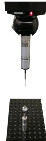
Figura 3.29. Proceso de calibración de la sonda táctil Renishaw SP25.
