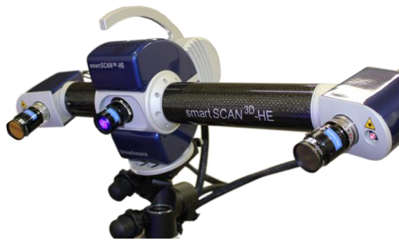
Figura 3.34. Escáner de luz estructurada Breuckmann smartSCAN 3D -HE – disponible en la UFI3D (ULE).
