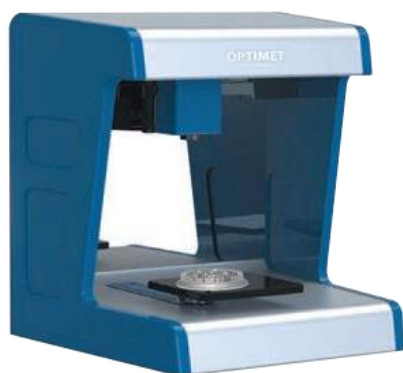
Figura 3.35. Sensor de holografía conoscópica ConoScan 4000 (Optimet, 2012) – disponible en los Laboratorios de Metrología (UNIOVI).
