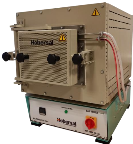
Figura 3.9. Horno de mufla de atmósfera controlada 12PR400CCH – disponible en la UFI3D (ULE).
