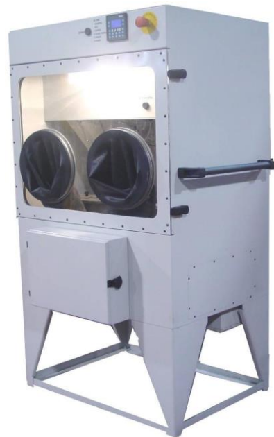
Figura 3.3. Tamizadora automática PX-BOX (3DSystems, 2012) – disponible en la UFI3D (ULE).
