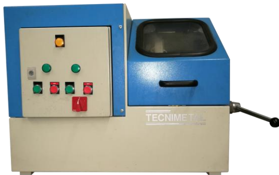
Figura 3.11. Cortadora metalográfica – disponible en la UFI3D (ULE).
