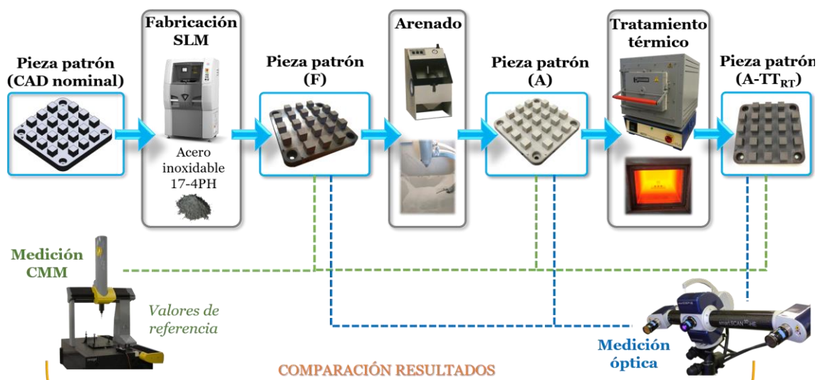
Figura 8.19. Metodología de evaluación de la influencia de diferentes postprocesos SLM en la inspección óptica de las piezas.
