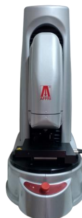
Figura 3.23. Durómetro automático Wiki 200 JS – disponible en el Laboratorio di Metallurgia dell'Università del Salento .
