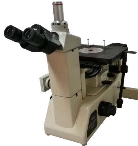
Figura 3.18. Microscopio metalúrgico invertido Epiphot 200 – disponible en el Laboratorio di Metallurgia dell'Università del Salento.
