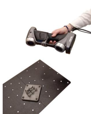
Figura 8.5. Medición óptica de la pieza patrón de esferas utilizando: (a) escáner láser instalado en CMM, (b) sensor de holografía conoscópica, (c) escáner láser integrado en CMA, (d) escáner láser portátil y (e) escáner de luz estructurada.
