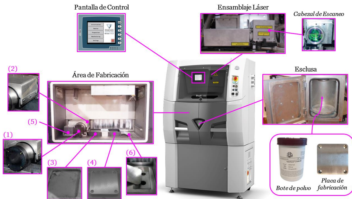
Figura 3.1. Impresora de metal ProX DMP 100 – disponible en la UFI3D (ULE).
