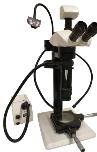
Figura 3.16. Macroscopio Leica Z16 APO – disponible en la UFI3D (ULE).
