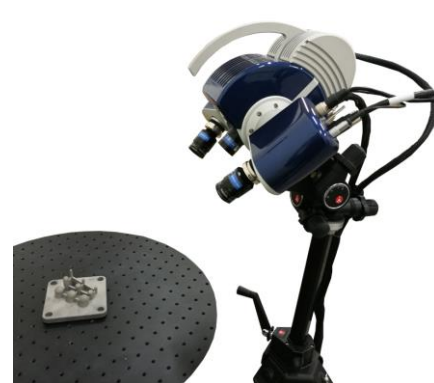
Figura 8.5. Medición óptica de la pieza patrón de esferas utilizando: (a) escáner láser instalado en CMM, (b) sensor de holografía conoscópica, (c) escáner láser integrado en CMA, (d) escáner láser portátil y (e) escáner de luz estructurada.
