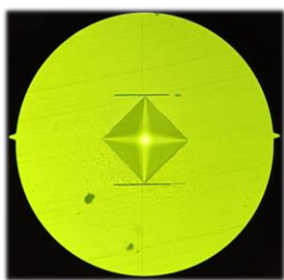
Figura 4.5. Huella en la superficie tras la realización del ensayo de dureza.
