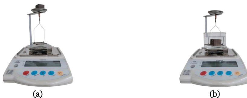
Figura 3.15. Balanza de precisión CB-Compleat – disponible en la UFI3D (ULE) – durante el proceso de medición de una muestra SLM: (a) en aire y (b) sumergida en agua.
