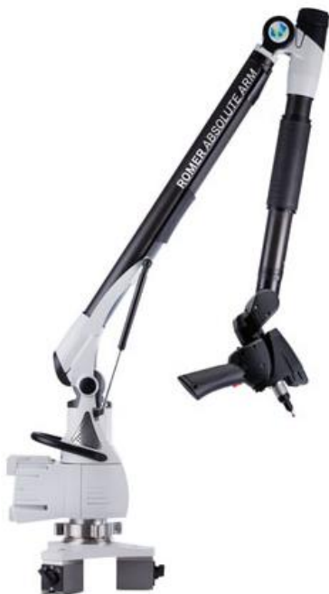
Figura 3.31. Romer Absolute Arm 7525 SI (con RS3) (Hexagon, 2015) – disponible en la empresa DOGRAM (Asturias).
