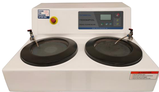
Figura 3.13. Pulidora metalográfica Teknipol – disponible en la UFI3D (ULE).
