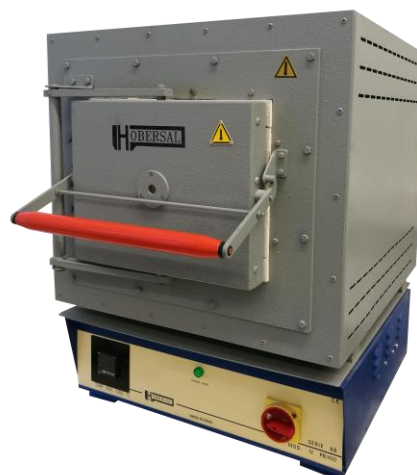
Figura 3.8. Horno eléctrico de mufla 12PR/400 – disponible en la UFI3D (ULE).
