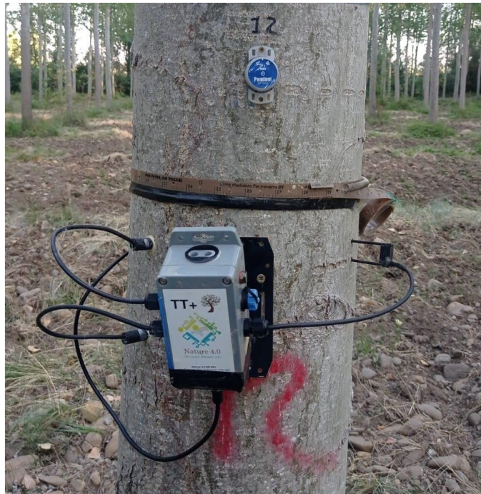
Figura 3-5. Pie VS_PIE12 sensorizado con el TT+, el sensor de temperatura HOBO Pendant y la cinta dendrométrica.
