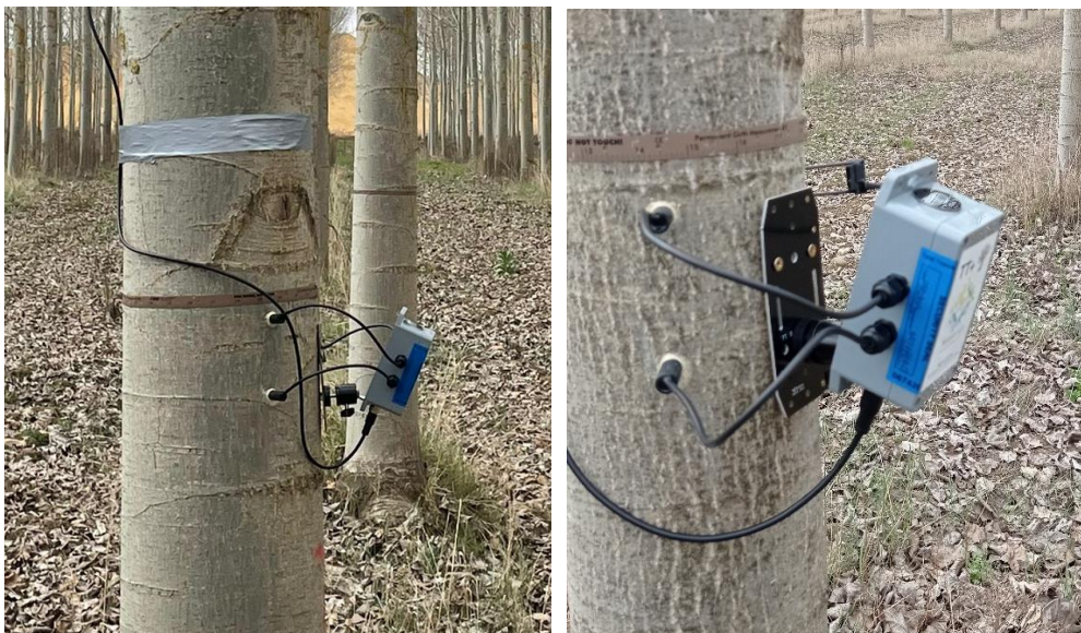
Figura 3-8. Disposición del TT+ a 20^\circ del tronco del árbol.
