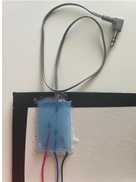
Figura 8.4. Transmisor de señal del ordenador al Arduino.
