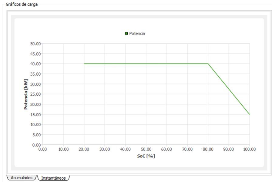
Figura 2.65. Simulador de recarga individual. Grupo Gráfico de carga. Instantáneos. (Fuente: Propio).
