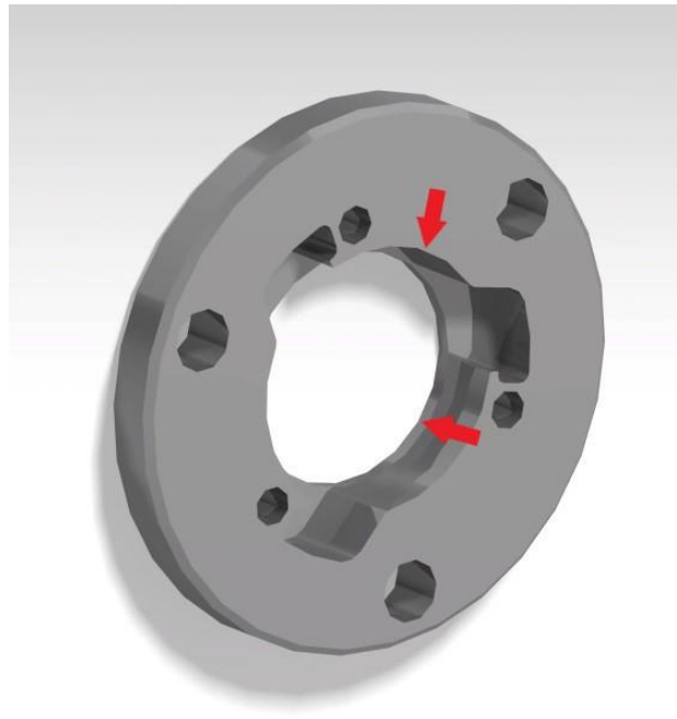
Figura 4.16 Vista en detalle del MANDRINADO_DESBASTE_2 de la base (Fuente: elaboración propia)
