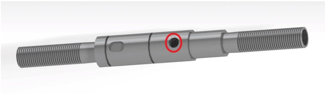
Figura 4.43 Vista en detalle del TALADRADO_1 del eje (Fuente: elaboración propia)
