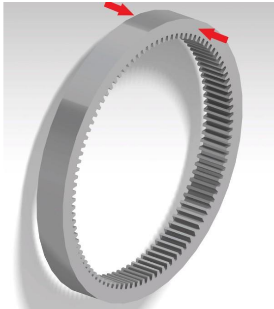
Figura 4.47 Vista en detalle del REFRENTADO_ACABADO_2 de la cremallera (Fuente: Elaboración propia)
