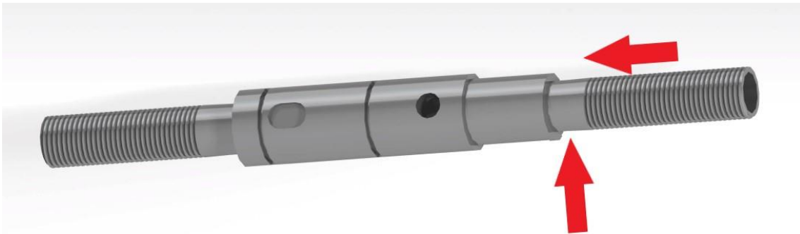
Figura 4.38 Vista en detalle del CILINDRADO_DESBASTE_1 del eje (Fuente: elaboración propia)
