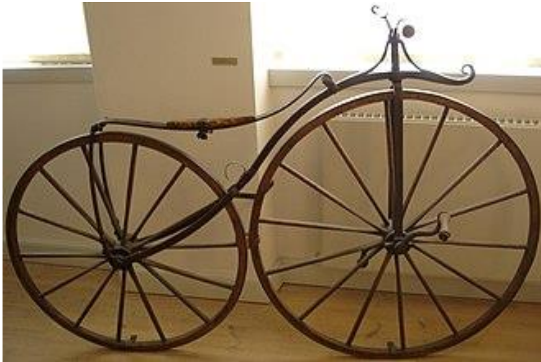
Figura 2.3 Diseño de bicicleta de Pierre Michaux (Fuente: [2])
