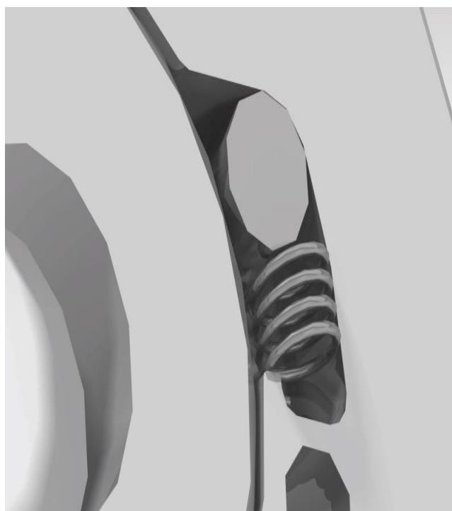
Figura 4.68 Colocación del taco de leva y el resorte en el interior de la base (Fuente: elaboración propia)
