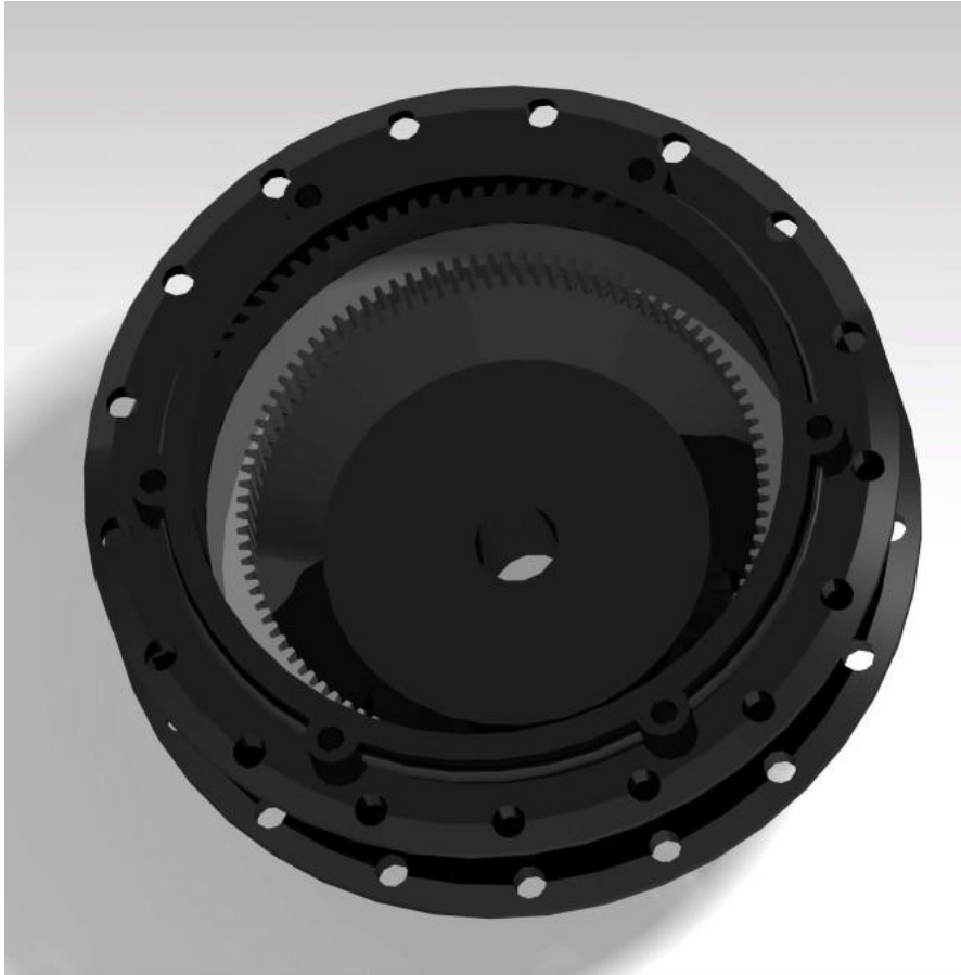
Figura 4.66 Montaje de la cremallera en el interior de la carcasa (Fuente: elaboración propia)
