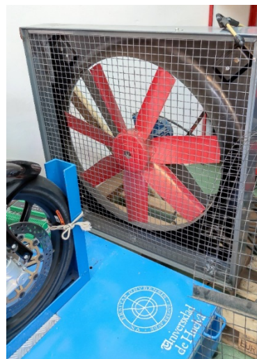
Figura 2: Ventilador con velocidad regulable.
