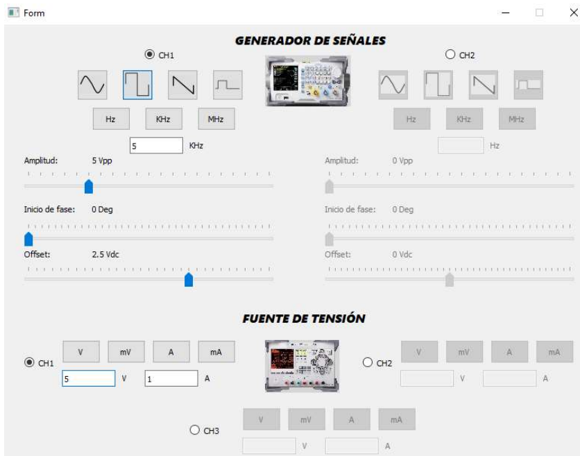
Figura 5.3. Interfaz fuente y generador del primer circuito.
