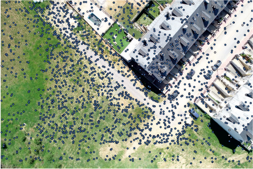
Figura 10. Ejemplo de puntos clave extraídos en una fotografía una vez eliminados los atípicos.
