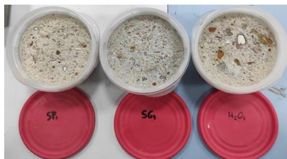
Figura 15. Muestra el daño superficial de los tres tipos diferentes de muestras tratadas con PS, GS y H2O en el ensayo de resistencia frente a ciclos de hielo-deshielo
