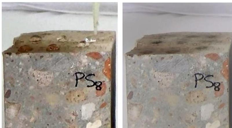
**Figura 16.** Ensayo de gota de agua
