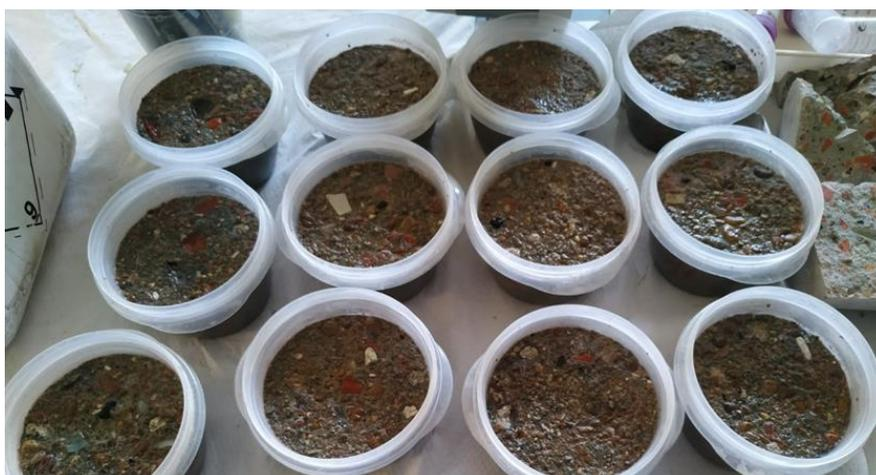
**Figura 9.** Probetas del ensayo de hielo-deshielo tras la retirada del material depositado tras 28 ciclos.
