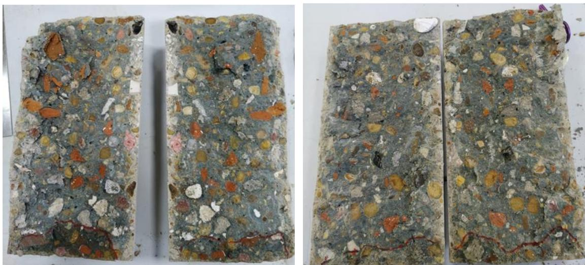
**Figura 8.** Muestras partidas a la mitad para la observación del frente de penetración tras la realización del ensayo de resistencia a altas presiones
