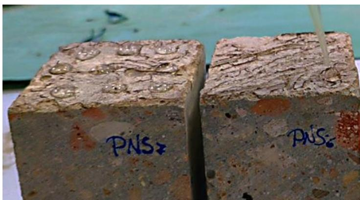
**Figura 10.** Probetas durante el ensayo de absorción de gota de agua
