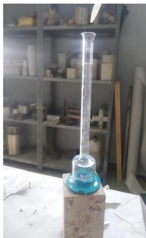
**Figura 5.** Tubo Karsten empleado para realizar el ensayo de absorción de agua a baja presión
