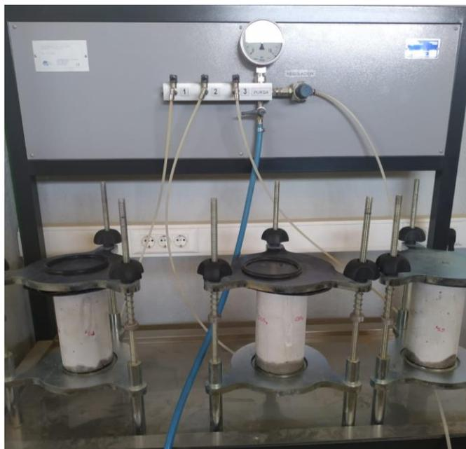
**Figura 7.** Probetas sometidas al ensayo de agua a altas presiones
