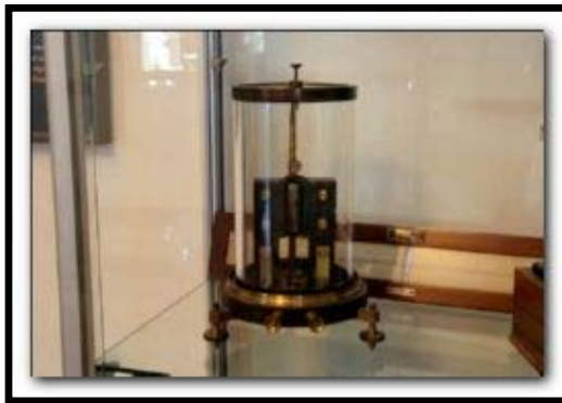
Fig. LXXIII. Galvanómetro de Tecnomasio italiano .
