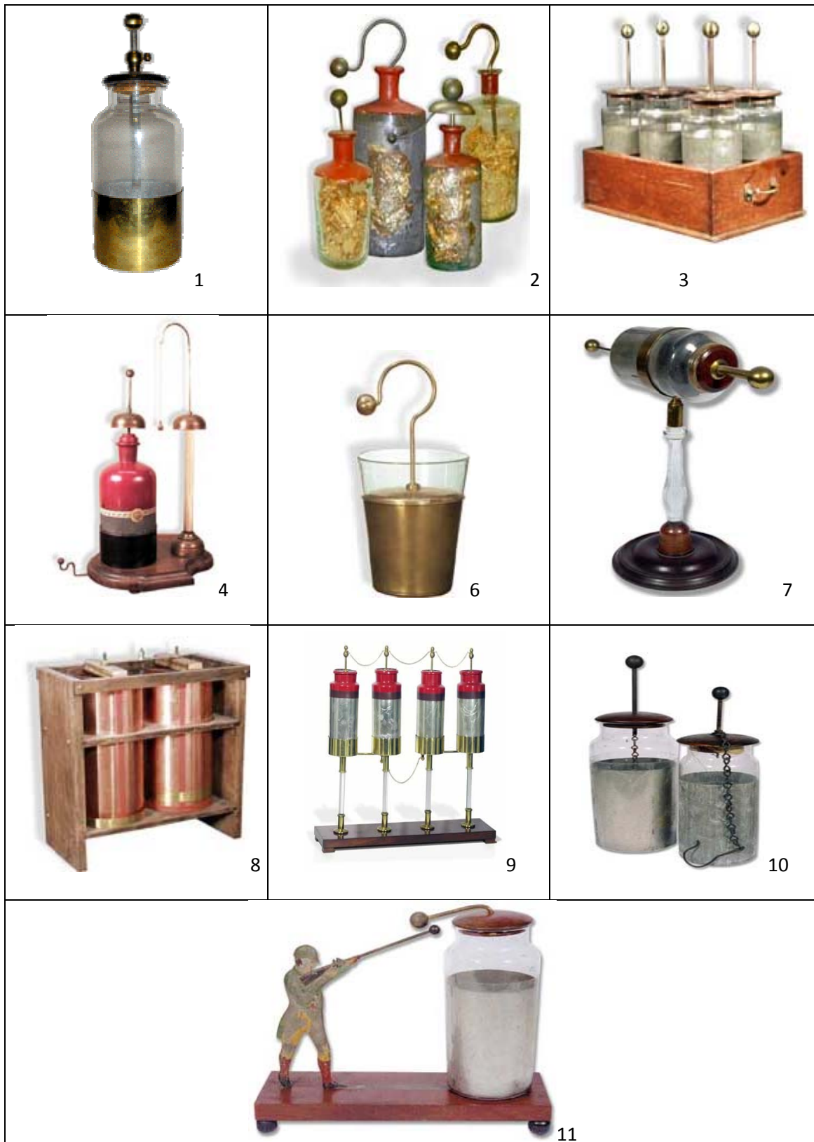
1-Botella de Leiden, 1885. 2-Botellas de Leiden de hojas de oro, primera mitad del siglo XIX. 3-Batería compuesta de seis botellas de Leiden. 4-Timbre de Franklin con una botella de Leiden, finales del s.XVIII. 5-Botella de Leiden con el electrómetro de Lane-1890 .6-Botella de demostración de Leiden. 7- Botella Horizontal de Leyden inglesa, 1830. 8-Botellas de Leiden, 1910. 9- Batería de Ducretet, 1865. 10- Botella de Leiden de Daniel Davis, norteamérica, 1840. 11- Batería decorativa de Joseph Wightman "Electrical Sportsman",1840.
