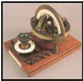
Fig. LXXIV: Brújula de tangentes presentada por Pouillet en 1837.
