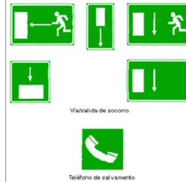
Imagen 1. Señales de evacuación
