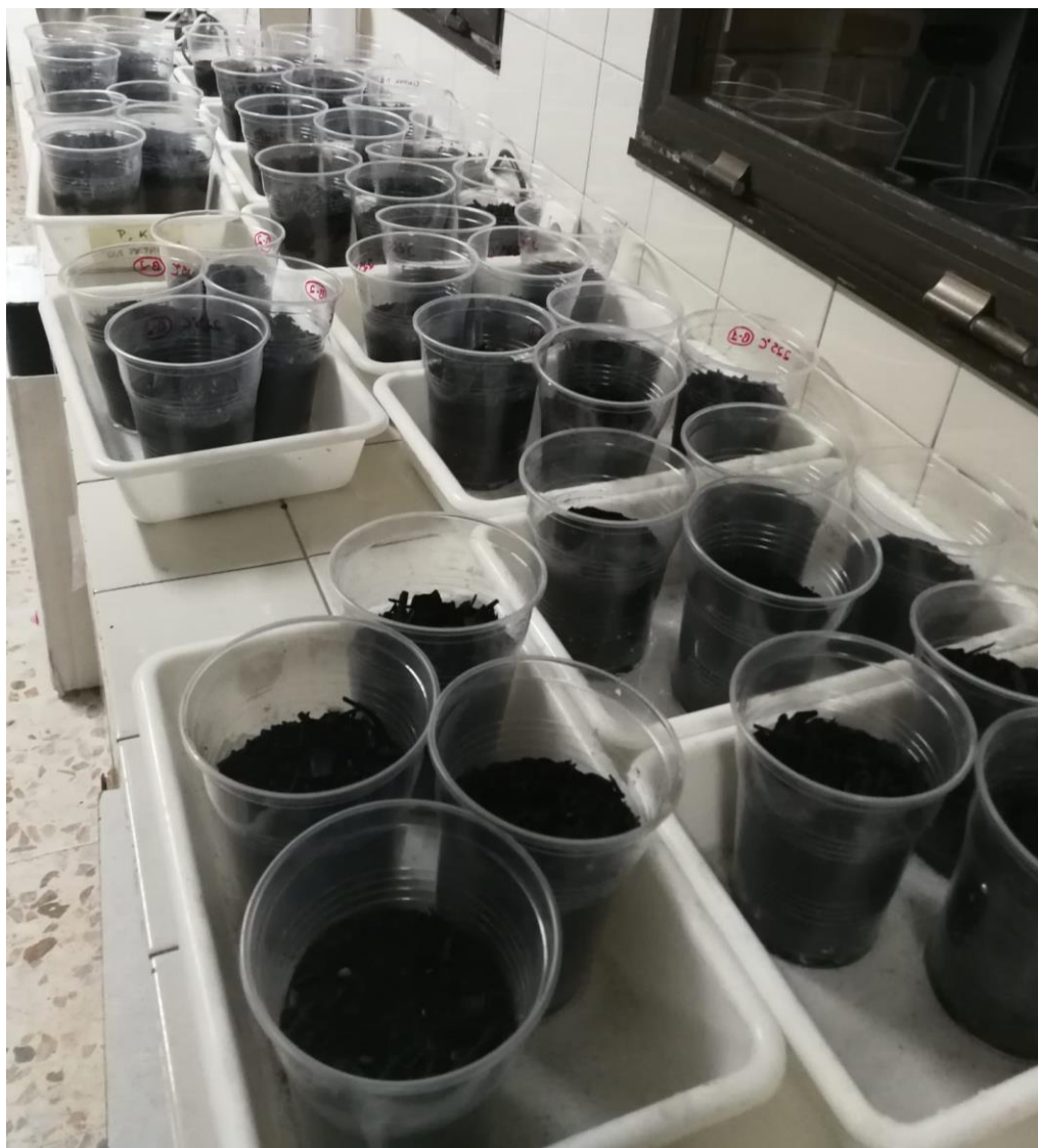
Figura 3. Macetas preparadas con cada tipo de biochar y severidad del fuego. Fuente: elaboración propia.
