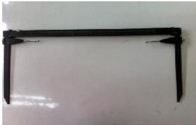
**Fotografía 3.** Antropómetro largo para mediciones antropométricas, modelo Gaucho (Rosscraft®, USA).
