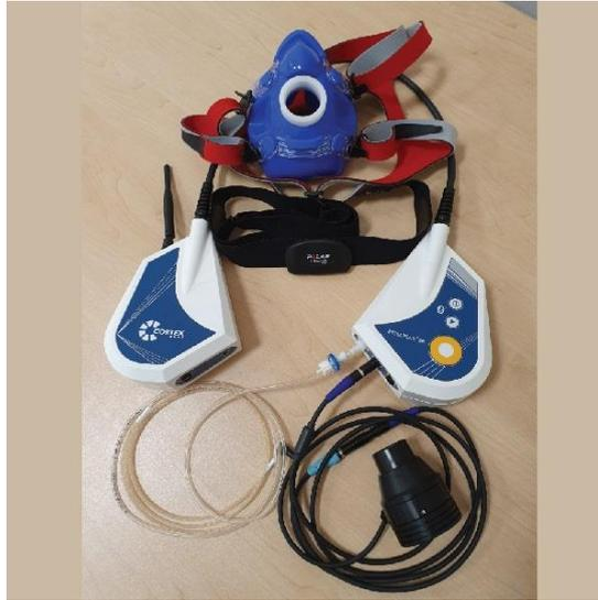
**Fotografía 6.** Equipo de gases Cortex Metamax® 3B, utilizado en el estudio.
