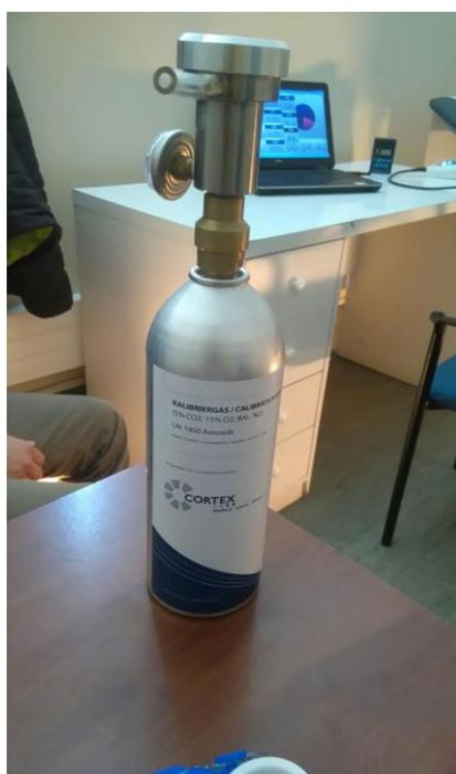
**Fotografía 9.** Gas de calibración para el equipo Cortex Metamax.
