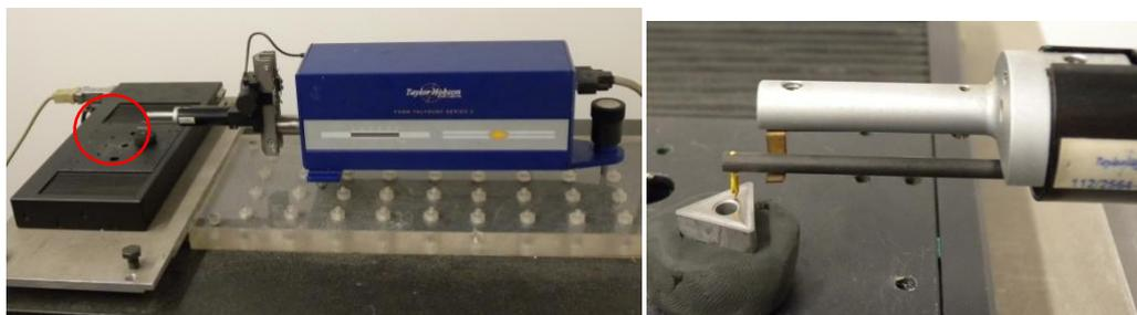
Figura 3-7: Medida del perfil geométrico de las herramientas.
