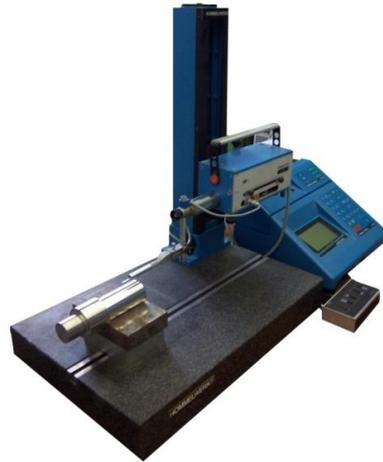
Figura 2-7: Rugosímetro HOMMELWERKE, modelo TKE 100/17.
