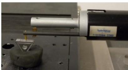
Figura 3-8: Medida de la rugosidad en la superficie de incidencia de las herramientas.
