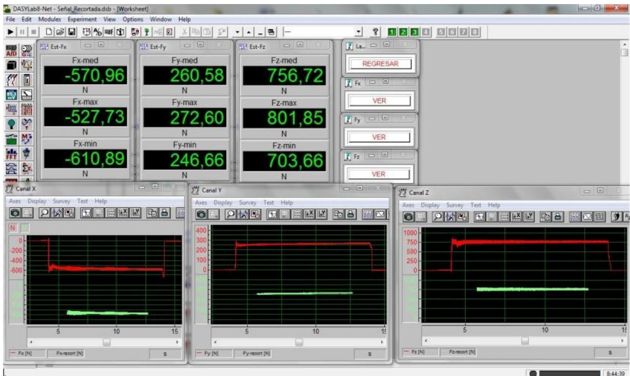
Figura 2-6: Aplicación para el tratamiento de las señales de fuerza en el entorno de DasyLab.
