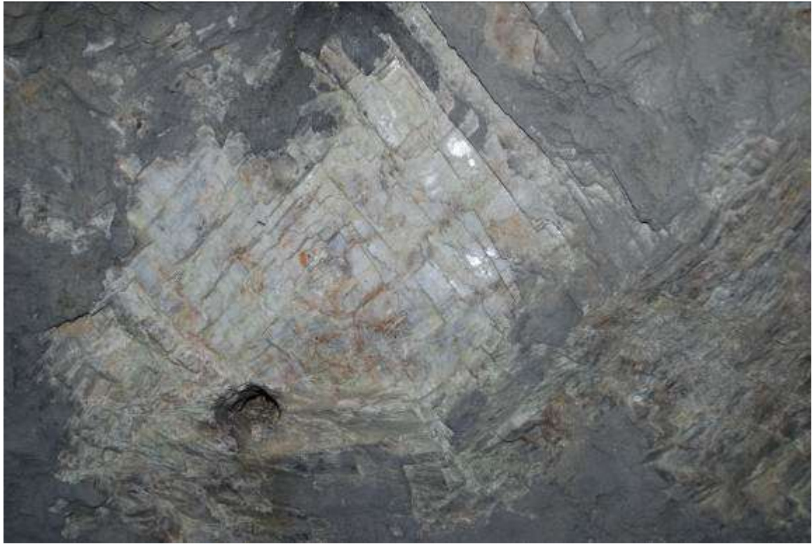
Fotografía 24001-MIN-006-1: Detalle del frente de explotación en el interior de una de las galerías. Pueden apreciarse los cristales de calcita en prismas rectangulares.
