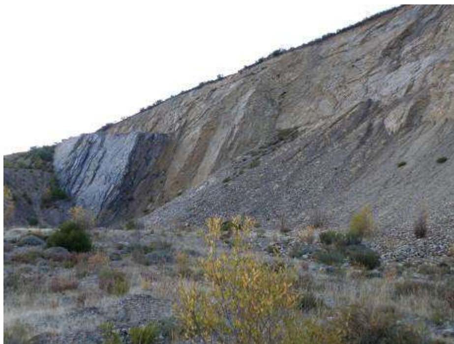
Fotografía 24169-PAL-010-01: Vista general de la zona más occidental de la pared que conforma este LIG. Se aprecia la disposición subvertical de las capas, el frente irregular de la pared resultante de las actividades extractivas y la persistencia, al fondo, de varias capas de carbón.
