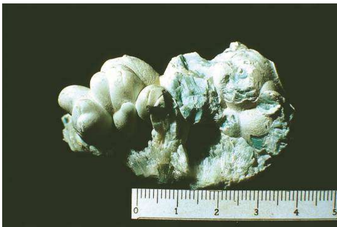
Fotografía 24901-MIN-008-1: Crecimientos mamelonares de aragonito verde-azulado de origen kárstico procedentes de la Mina "La Profunda"
