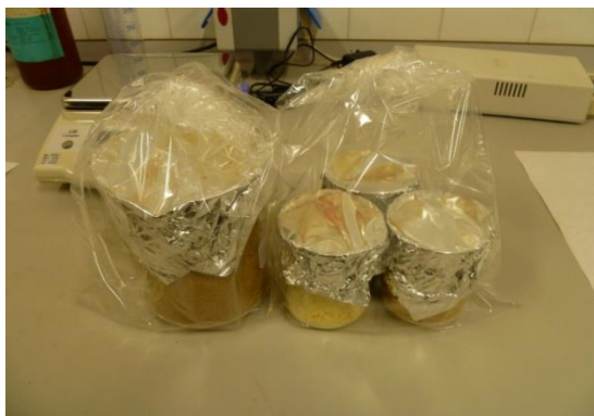
Figura 4.13: Vasos de precipitados con serrín de roble, germen de trigo, levadura de cerveza y harina de maíz para autoclavar.
