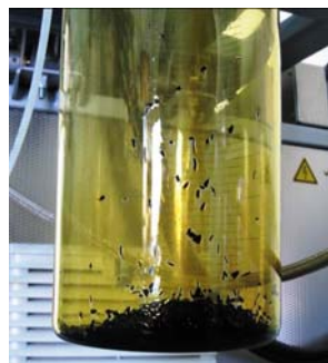
Figura 5.6 Efecto de la condensación de alquitranes en el char
