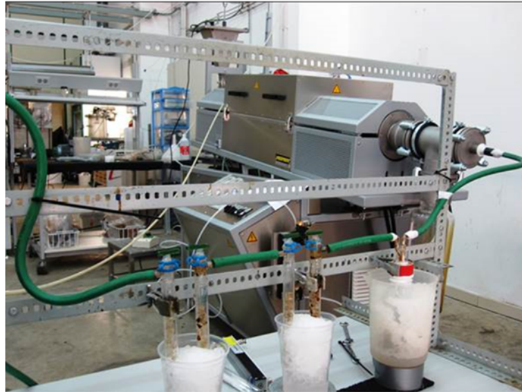
Figura 5.3 Disposición en flujos paralelos
