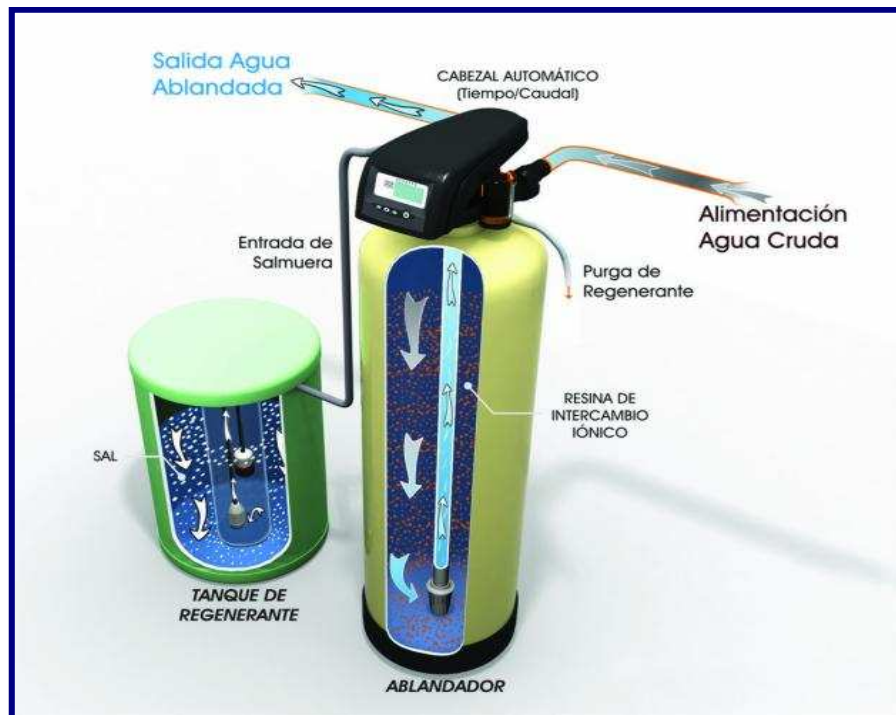
Figura 4.19: Esquema de funcionamiento de un ablandador ( www.acqualive.com.ar )
