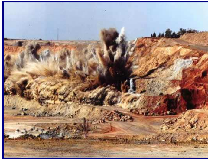
Figura 2.10: Voladura de rocas con explosivos
