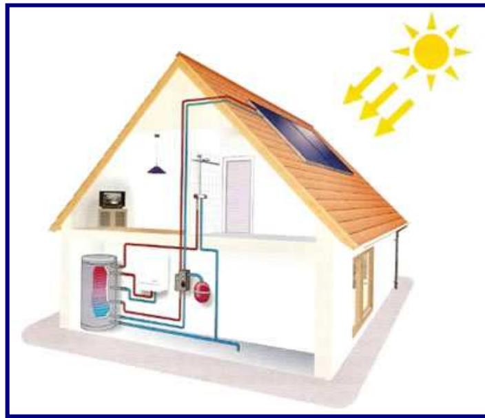
Figura 8.1: Esquema de una instalación solar para ACS ( www.zyzclima.com )
