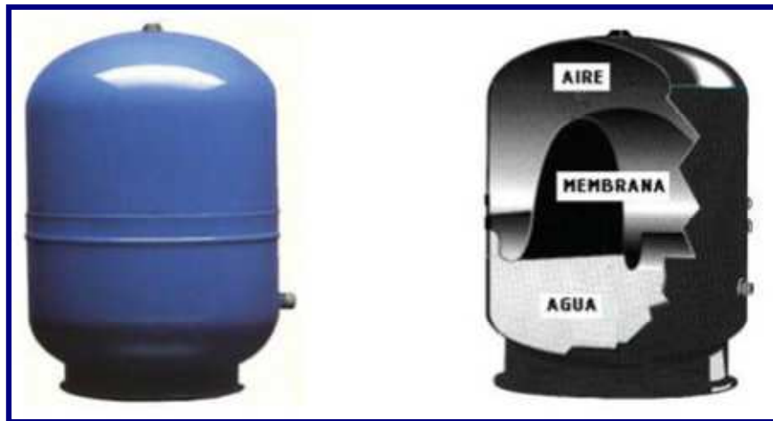
Figura 3.28: Vaso de expansión cerrado (Grau)
