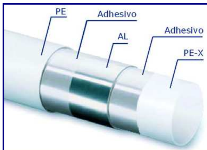
Figura 5.19: Esquema constructivo de tuberías multicapa ( www.arqhys.com )
