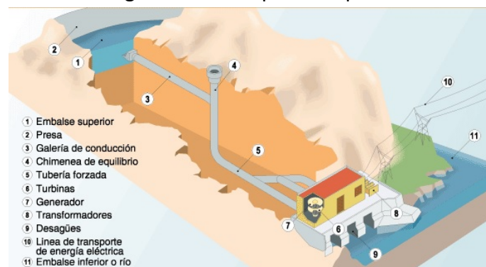
Figura 2-24: Central de bombeo. Fuente: [41]
