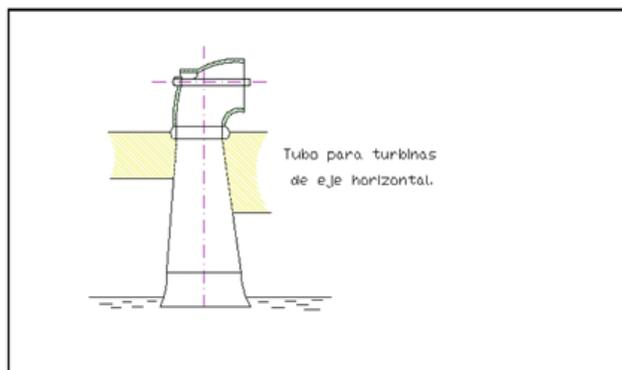
Figura 6.5 Tubo de aspiración para turbina Francis de eje horizontal
