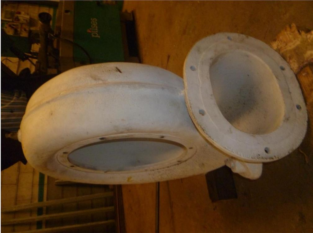
Figura 115.5 Cámara espiral de la turbina
