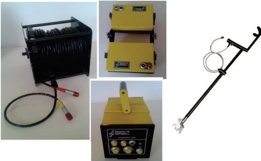
Figura 4-8 Partes que componen el georradar
