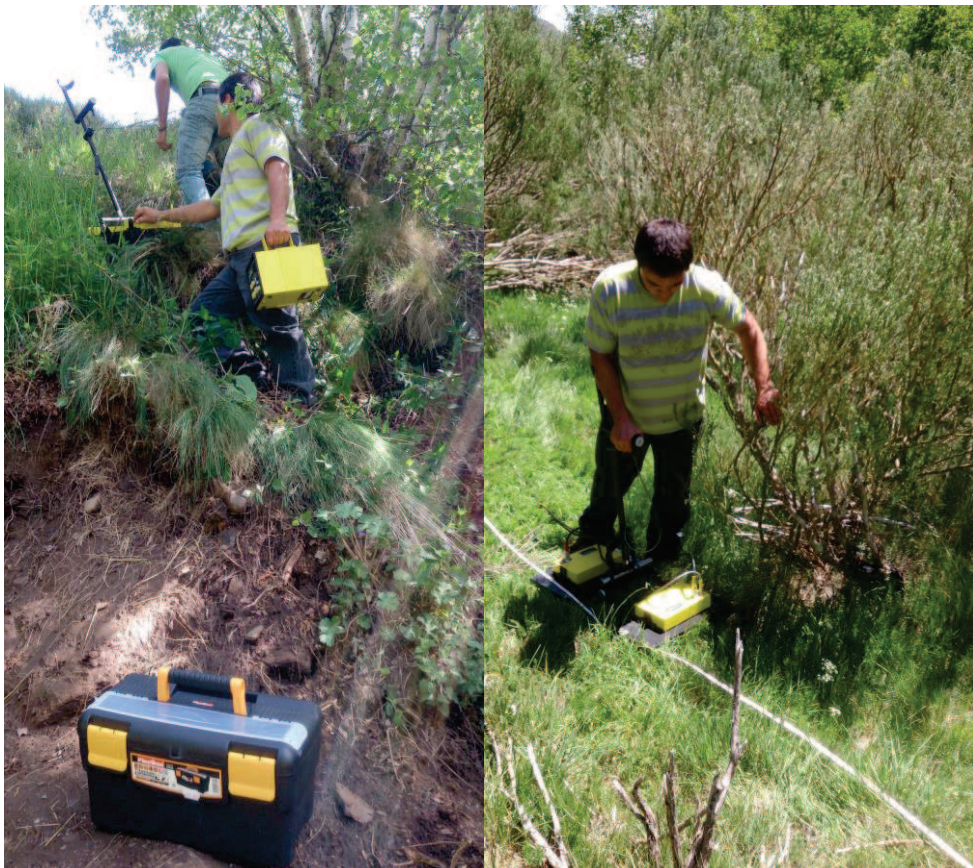
Figura 4-11 Transporte del equipo a la izquierda y antenas del georadar mientras se realiza un perfil
