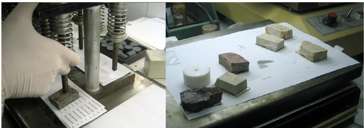
Figura 3.4.- Eliminación de las burbujas aplicando presión y a la derecha plancha caliente con muestras.
