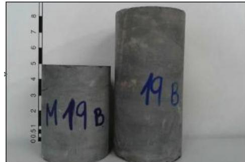
Figura 5.6: Extracción de probetas a partir de las muestras de afloramientos
