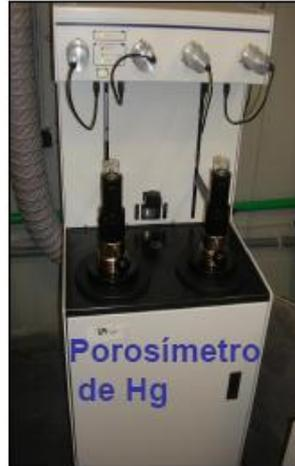
Figura 5.8: Equipo de porosimetría al Mercurio
