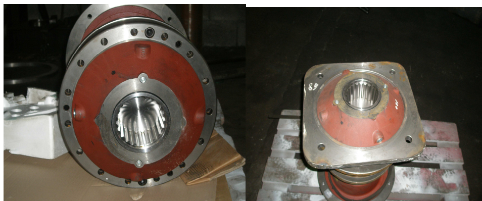
Figura 6.3- Reductor en fase de construcción
