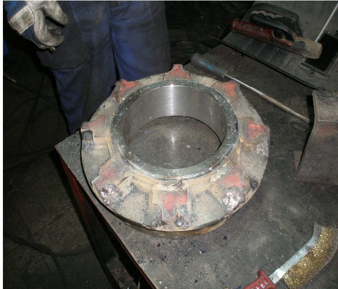
Figura 4.2.2.- Detalle de estación motriz en proceso de fabricación
