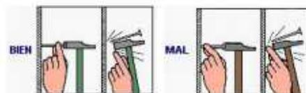
**Figura 5.** Forma de sujetar un clavo antes de clavarlo.
