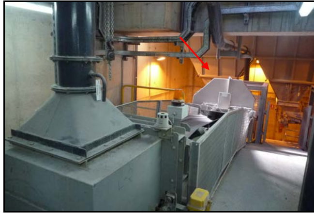
Figura 5.5. Sistemas de muestreo sobre las Cintas de Descarga de Caliza.
