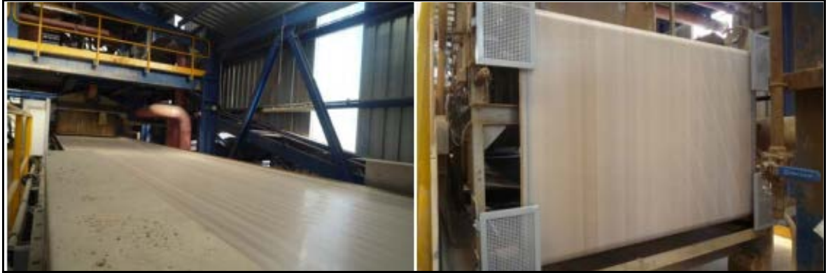
Figura 5.39. Filtro de Banda de Vacío.
