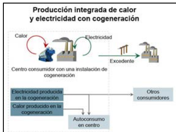
Figura 3.9. Esquema de producción integrada con cogeneración.
